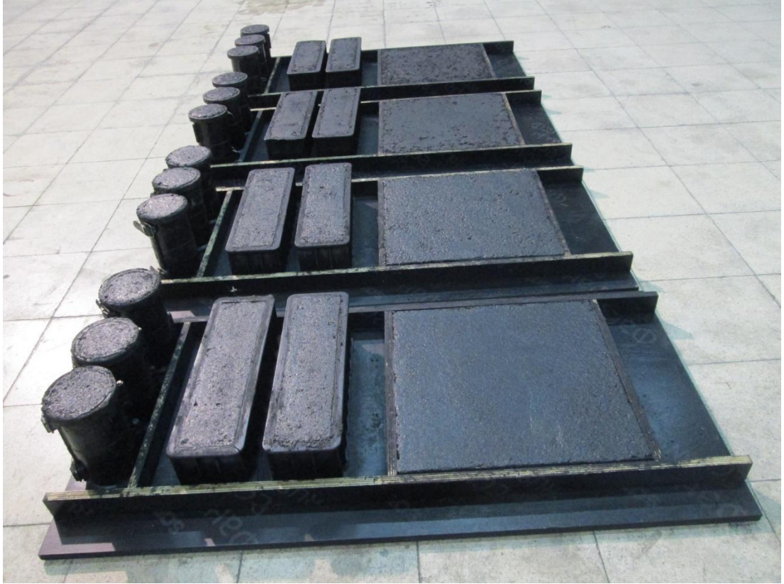
Şekil D.3. ATE içeren numune gruplarının kalıplanması.
