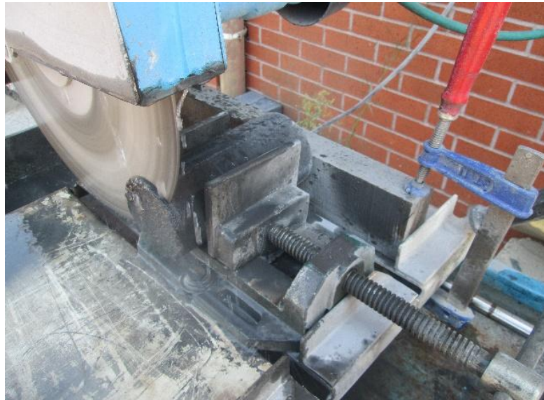
Şekil 3.11. Silindir numunelerin pürüzlü taraflarının kesilmesi.
