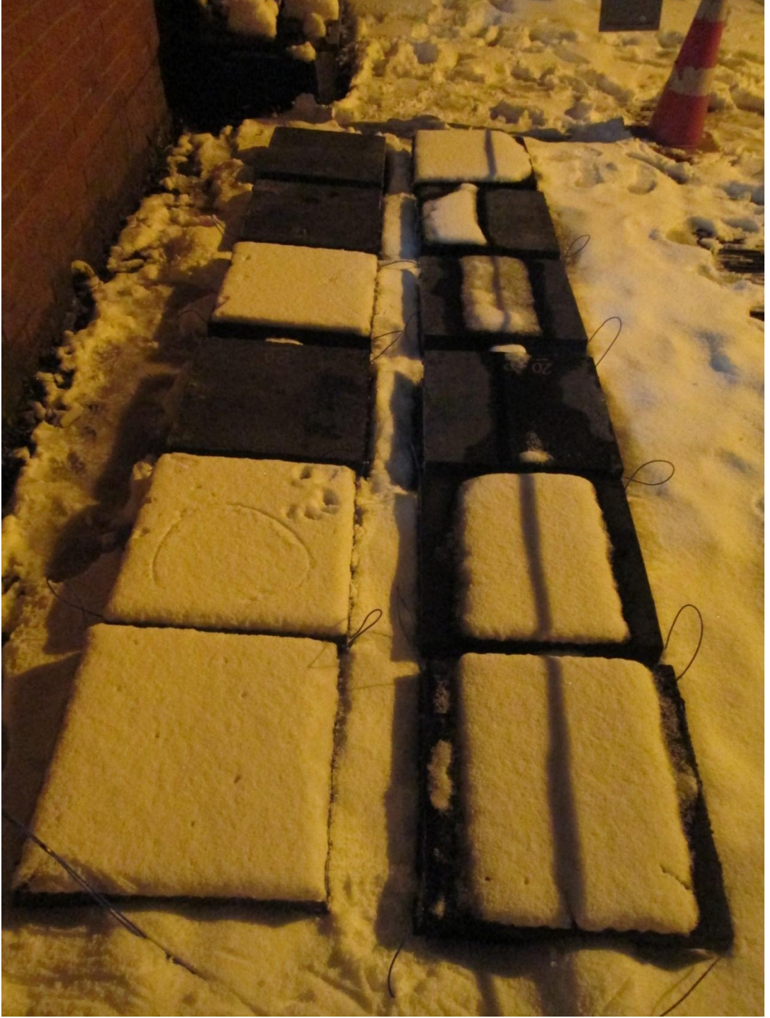
Şekil D.7. karlı havada plaka numunelerin voltaj uygulama sonrası.
