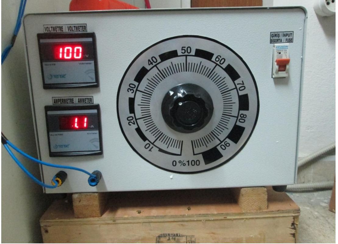
Şekil D.4. 0 ile 220 V arasında ayarlanabilir varyak.
