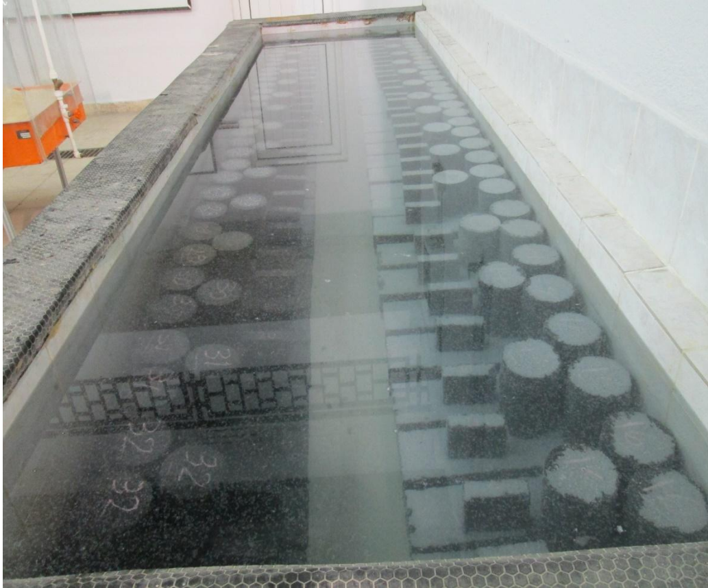
Şekil 3.10. Numunelerin kür havuzunda yerleştirilmesi.
