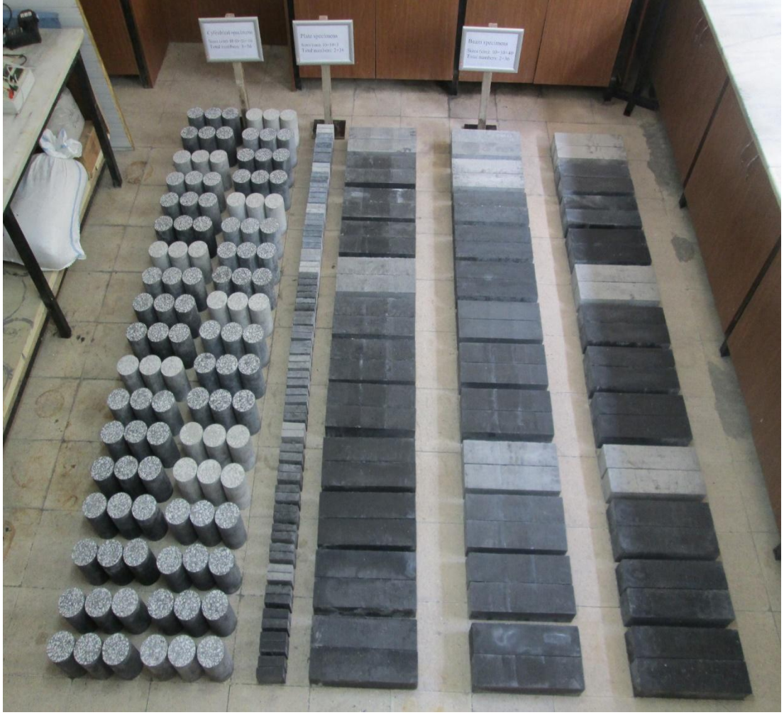
Şekil 3.12. Numunelerin oda sıcaklığında kurutulması.
