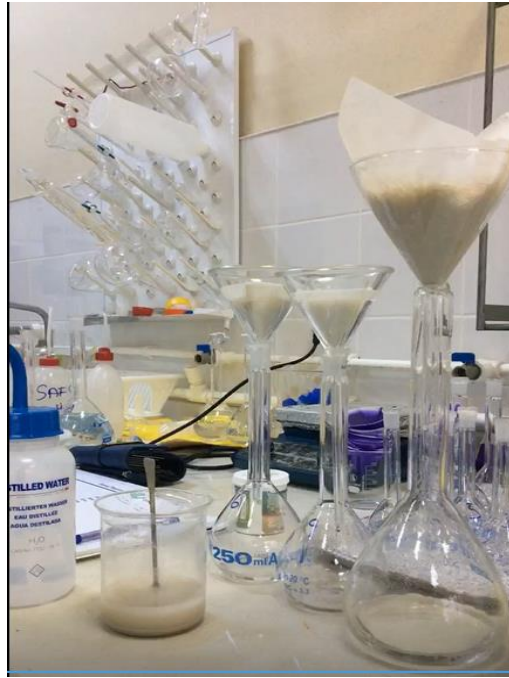
Şekil 5.1. Montmorillonit mineral saflaştırma işlemi.
