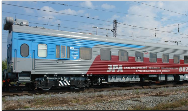
Şekil 3.12. Demiryolu ölçüm treni (Infotrans, 2018).
