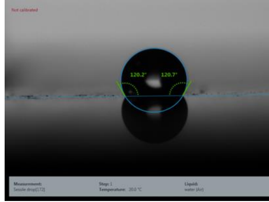
Şekil 4.6. Hidrofobik kaplamalı plakanın temas açısı ölçüm görseli
