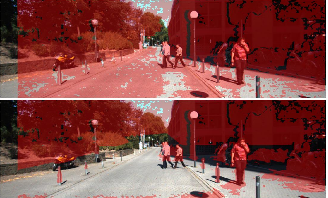
Şekil 4.19. '2011_09_28_drive_0038-063' nolu test görüntüsü engel tespit sonuçları; tez aşamasında önerilen yöntem (üst), Hough dönüşümü ile elde edilen engeller (alt).
