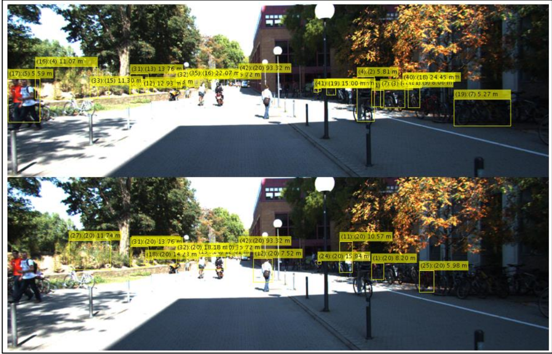
Şekil 3.62. Aynı segmentlerin farklı çerçeve dolgu miktarları kullanılarak HOG filtresine gönderildiğinde elde edilen sonuçlar.
