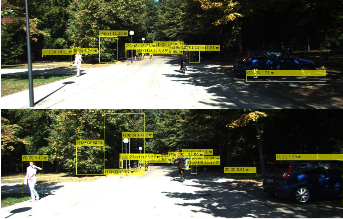
Şekil 4.37. Uzaklık tabanlı alansal eşikleme öncesi elde edilen pozitif HOG sonuçları ve uzaklıkları.
