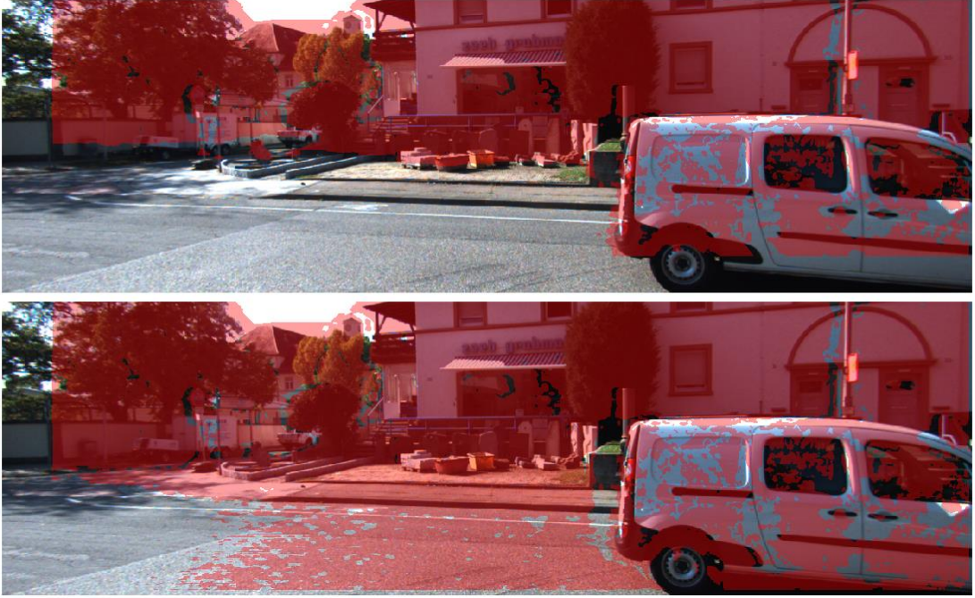
Şekil 4.12. '2011_09_26_drive_0070-003' nolu test görüntüsü engel tespit sonuçları; tez aşamasında önerilen yöntem (üst), Hough dönüşümü ile elde edilen engeller (alt).
