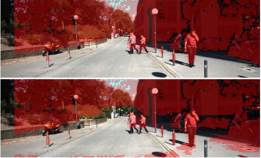
Şekil 4.22. Eğim sınırlaması yapıldıktan sonra engel tahmini önerilen metot (üst), Hough dönüşümü (alt) sonuçları.
