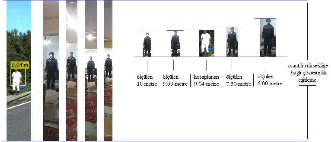
Şekil 3.68. Uzaklık hesaplaması doğrulama testleri (375 piksel yüksekliğe orantılı eşitleme).
