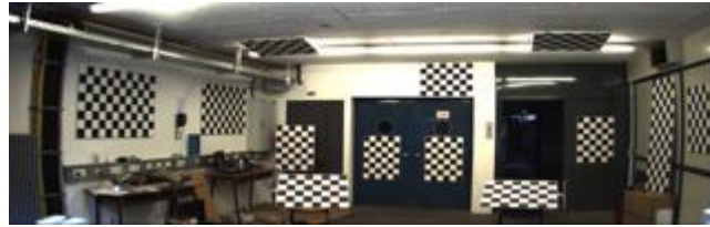
Şekil 2.3. KITTI veri tabanı kalibrasyon test görüntüsü [55].
