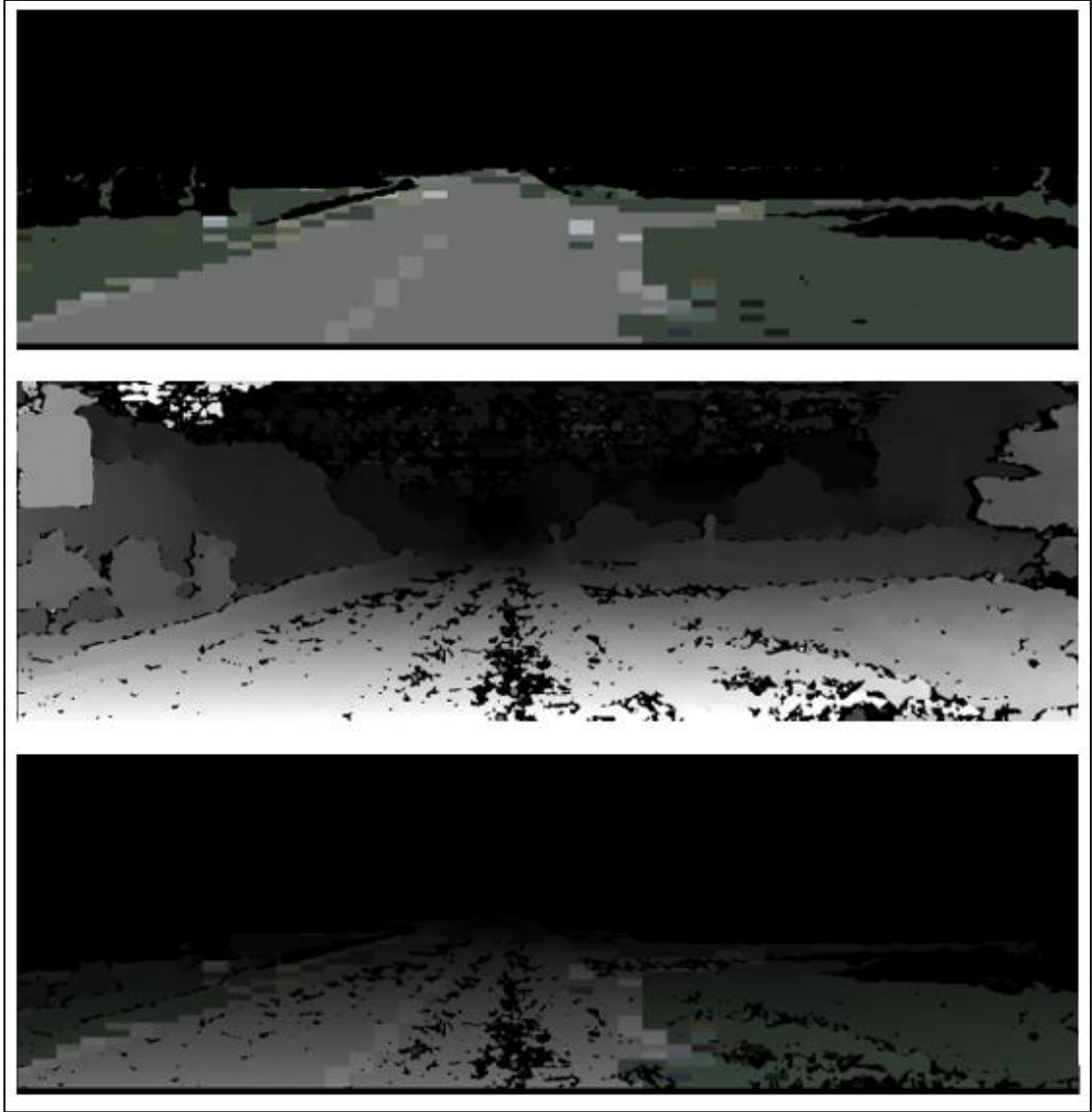
Şekil 3.50. GDD renk segmentasyonunun yer düzlemindeki görüntüsü (üst), Derinlik haritası (orta), Yer düzlemi renk bölgelerinin derinlik bilgisi eklendiğindeki görünümü (alt).
