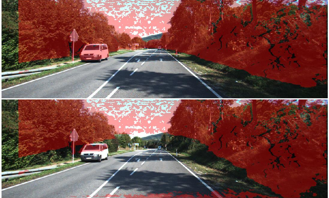
Şekil 4.9. Veri seti '2011_09_26_drive_0070' ve '414' nolu görüntü verisi kullanılarak oluşturulan önerilen metotla elde edilen engel çıktısı (üst), Hough dönüşümü yöntemiyle elde edilen engel verisi çıktısı (alt).
