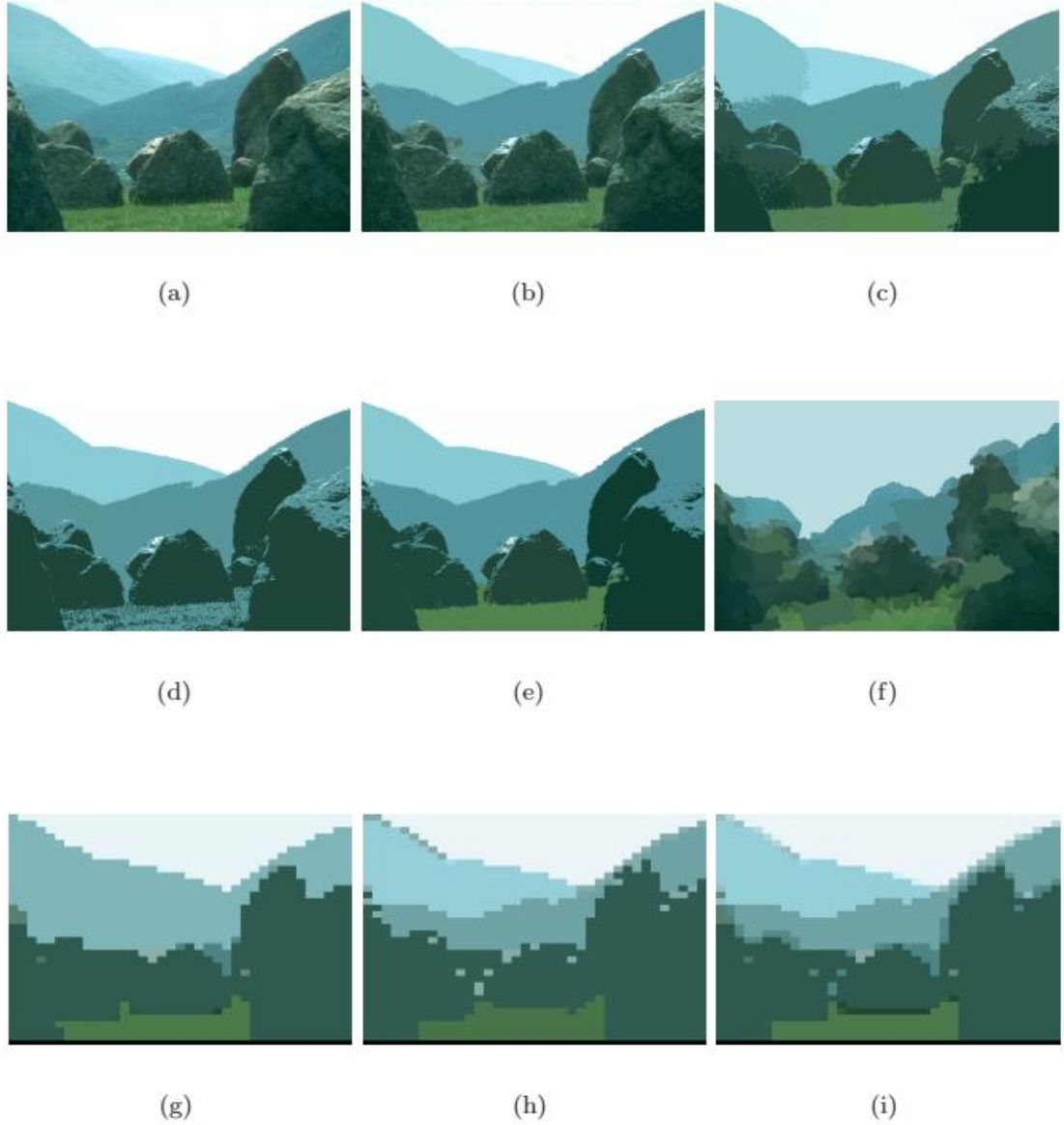
Şekil 3.10. Taşlar görüntüsü (204x153 piksel) segmentasyon karşılaştırma sonuçları: (a) Orjinal görüntü, (b) K-means renk segmentasyonu, (c) K-means uzamsal segmentasyon, (d) Mean-Shift renk segmentasyonu (e) Mean-Shift uzamsal segmentasyon, (f) Normalized-Cut segmentasyonu, (g) ADP+GDD segmentasyonu, (h) MeanHSV+GDD segmentasyonu, (i) GDD segmentasyon sonucu.
