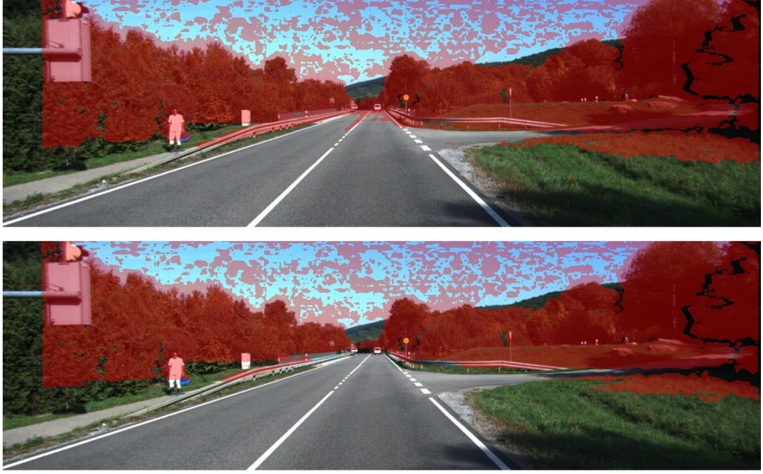
Şekil 3.32. 2011_09_26_drive_0070 seti 355'nolu görüntüde; kamera etkisi hesaba katılmadığında elde edilen engeller (üst) ve önerilen yer düzlemi tahmini ile elde edilen engel (alt) görüntüleri.
