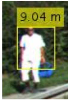
Şekil 3.67. Bulunan yaya üzerinden hesaplanan uzaklık tespiti.
