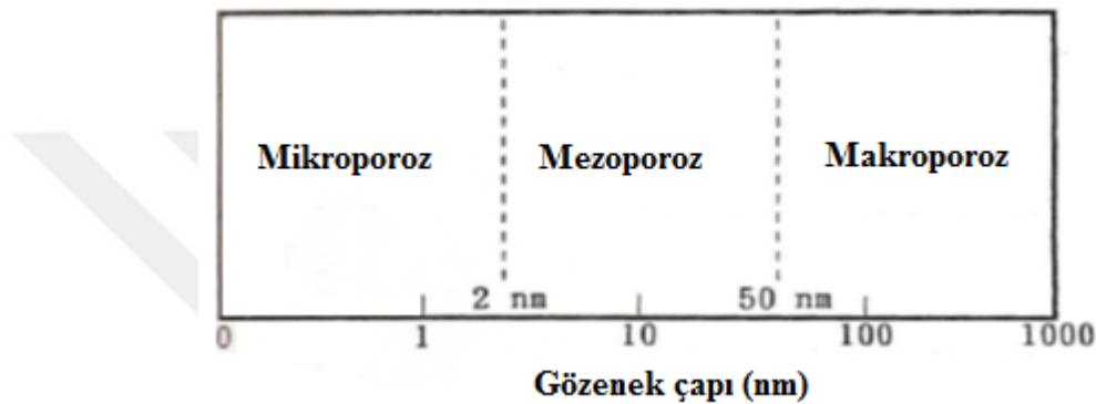
Şekil 3.2. Gözenek boyutuna göre gözenekli malzemelerin sınıflandırılması [31].
