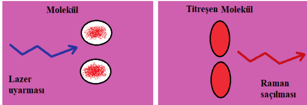
Şekil 3.8. Raman etkisinin şematik gösterimi [102]
