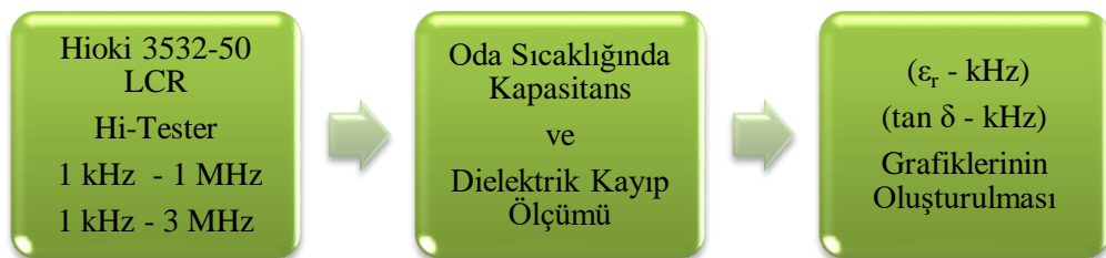
Şekil 3.9. Seramik numunelerin elektrotlama işleminden sonraki aşamaları
