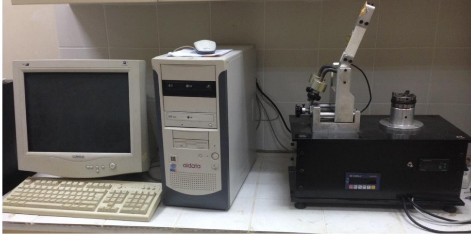
Şekil 4.8. Aşınma deneylerinde kullanılan ball-on disk aşınma cihazı ve ekipmanları
