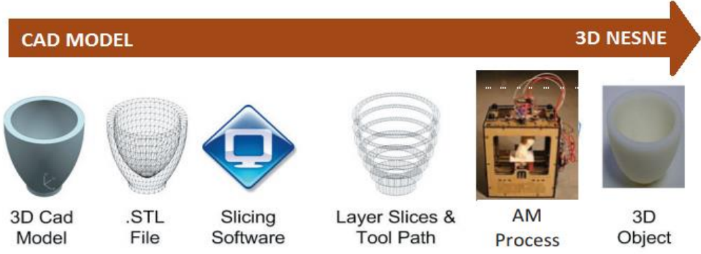
Şekil 30: Katmanlı Üretimin Genel Süreci
