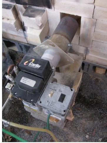
Görsel 107: Damlama Plakalı Brülör Sistemi, Shippensburg Üniversitesi, USA,2018
