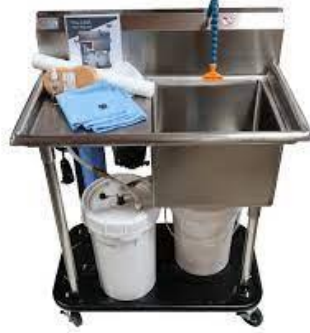
Görsel 103: Taşınabilir Kil ve Su Filtreleme Geri Dönüşüm Sistemi, İzlanda, 2023
