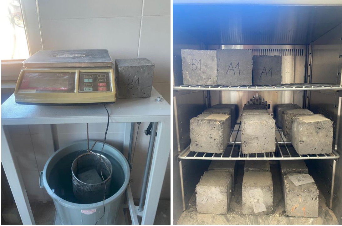
Şekil 3.13. Sertleşmiş betonda su emme deneyine ait görseller.
