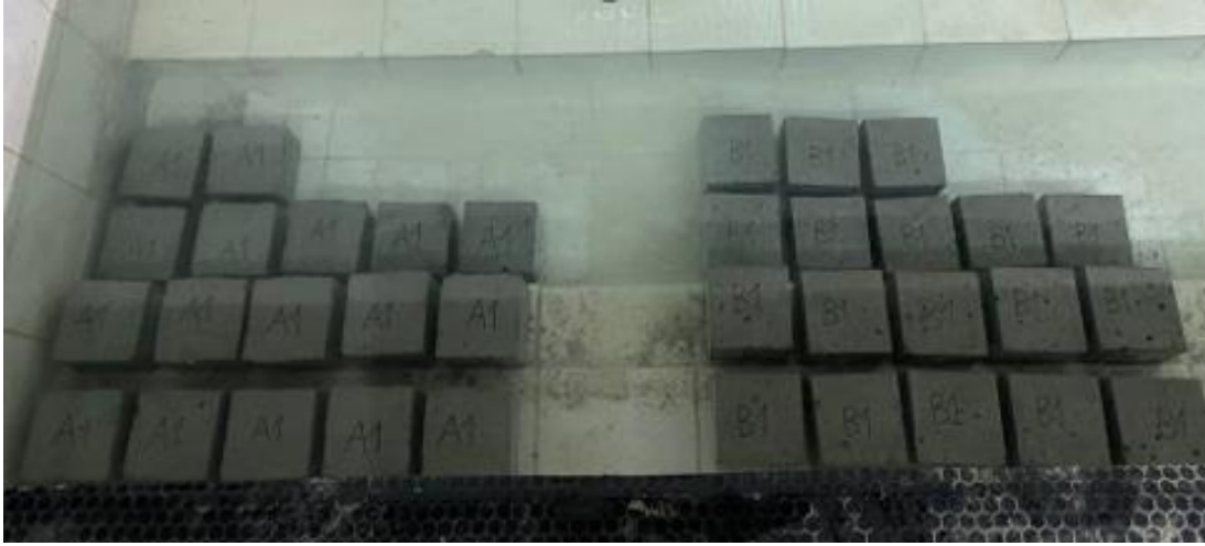
Şekil 3.12. Standart küre bekletilen beton numuneler.
