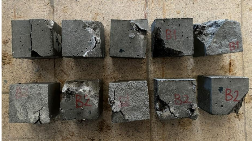
Şekil 4.2. Standart kür esnasında çatlayan cürüflü numuneler.
