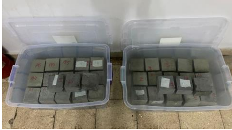
Şekil 3.16. MgSO 4 ve Na 2 SO 4 çözeltilerindeki beton numuneler.
