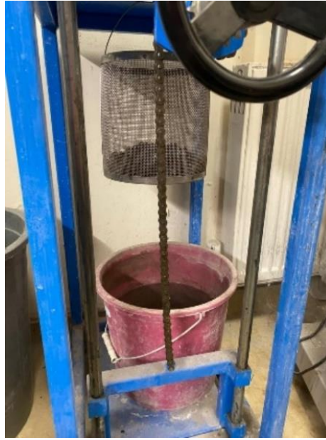
Şekil 3.6. Kaba agreganın sudaki ağırlığının ölçümü.
