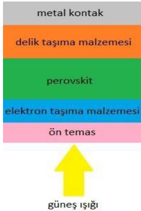
Şekil 3.1. Perovskit güneş pilininin basit bir şematik görünümü
