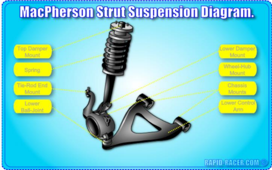
Şekil 6.1. MacPerson sistemindeki salıncak gösterimi [25].
