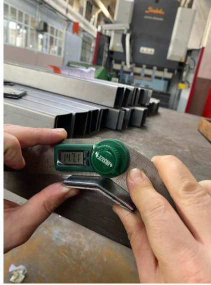
Şekil 4.11. Bükümü yapılan deney numunesinin dijital açı ölçer ile ölçümü
