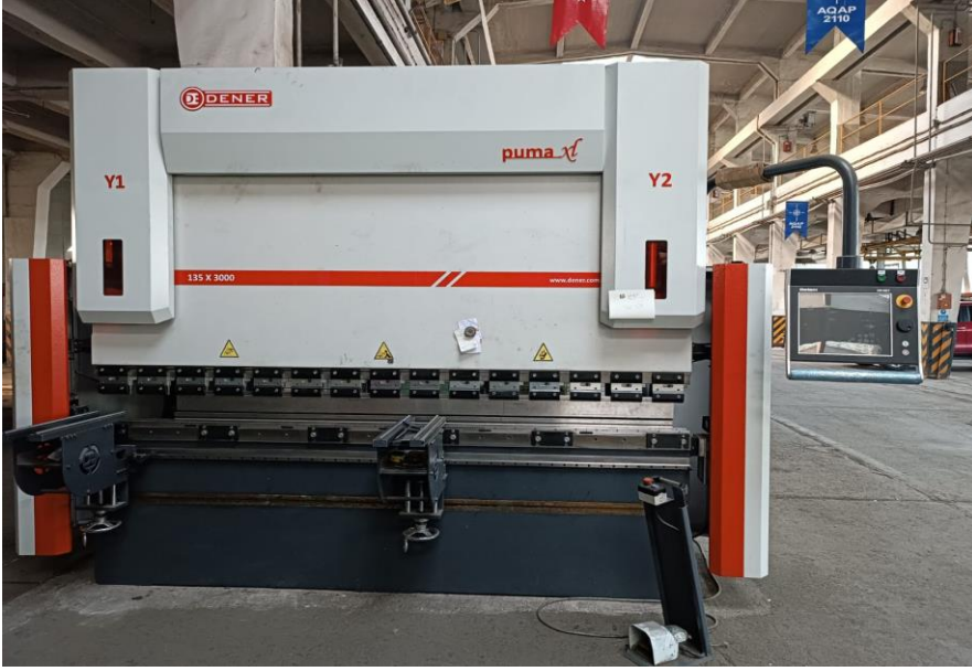
Şekil 4.7. V Bükme deneylerinde kullanılan CNC Abkant Pres
