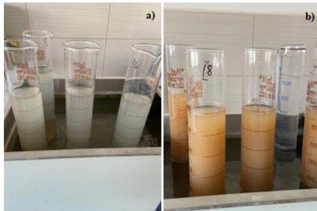
Şekil 5.4. Deney öncesi ayırıştırıcı madde ile bekletilmemiş (a) ve bekletilmiş numuneler (b).
