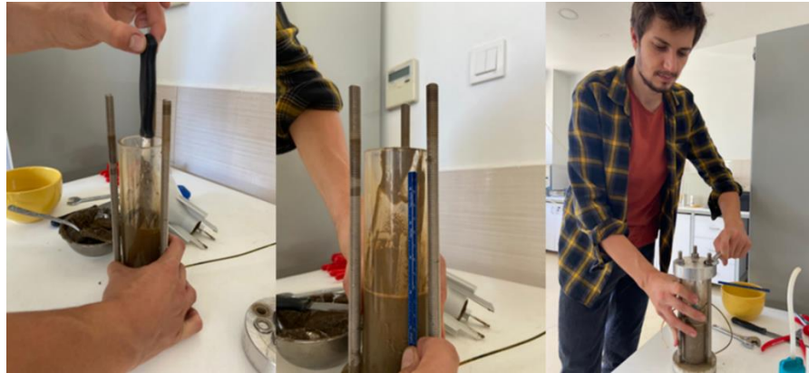
Şekil 5.19. Bulamaç (slurry) yöntemi şematik gösterimi.
