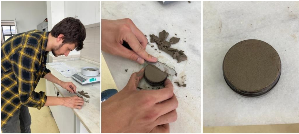
Şekil 5.21. Numunenin konsolidasyon halkasına yerleştirilmesi.
