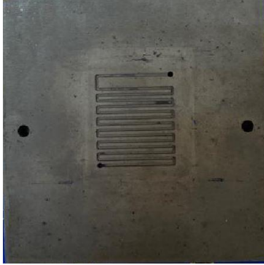
Şekil 1.10. Tez çalışmasında kullanılan serpantin akış tasarımlı bipolar plaka.
