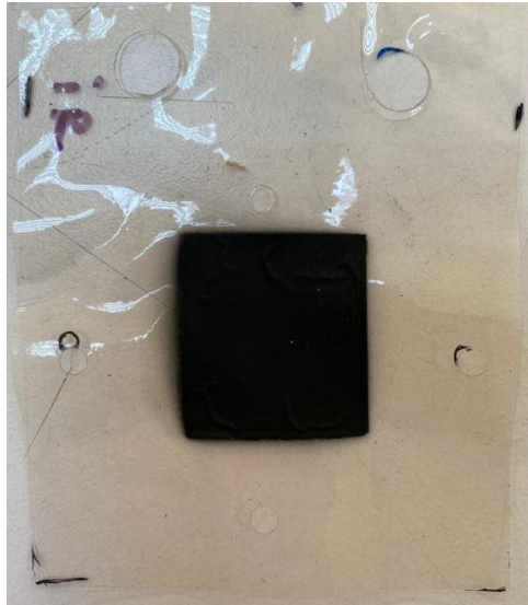
Şekil 1.8. Tez çalışmasında kullanılan membran elektrot ünitesi.
