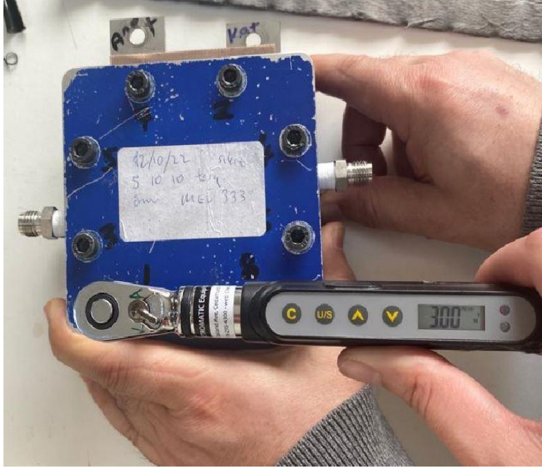
Şekil 5.10. Torkmetre ile PEM elektrolizör hücresine sıkıştırma torkunun uygulanması.
