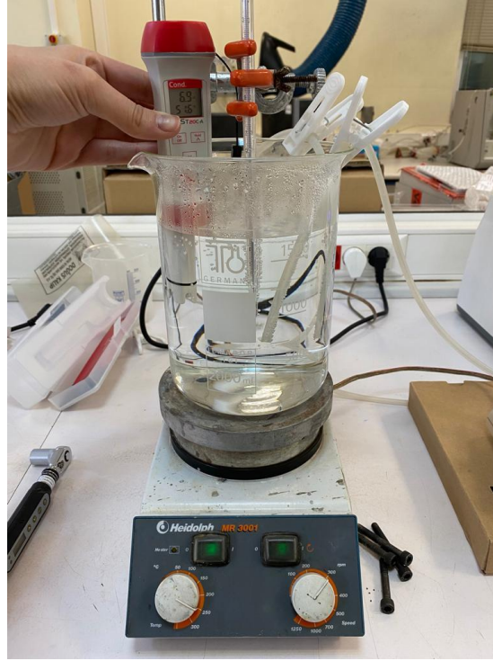
Şekil 4.3. Saf su kalem tip iletkenlik ölçer.
