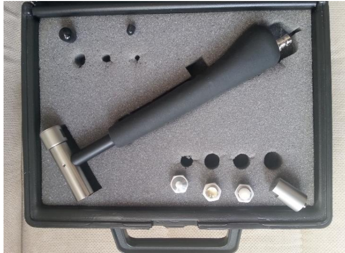
Şekil 3.11. Deneysel modal analizde kullanılan modal çekiç.
