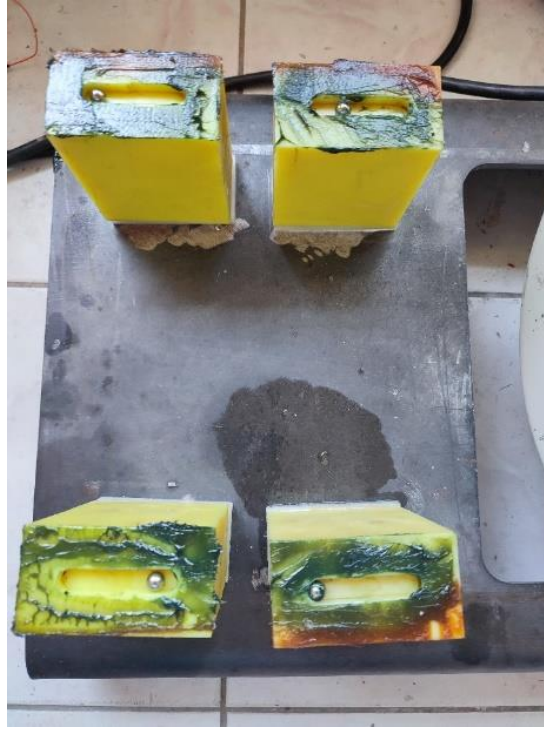
řekil 3.16. Sarsıcı, yatay tabla altındaki polyamid destekler, tabla ile destekler arasına konulan bilyeler ve yađ.
