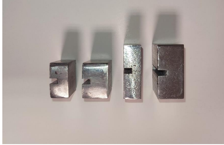
Şekil 3.6. DTS'lerin oluşturulmasında kullanılan uç kütleler.
