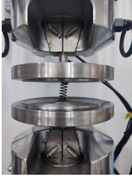
Şekil 3.20. Basma testi yapılan ana sistemdeki yay.
