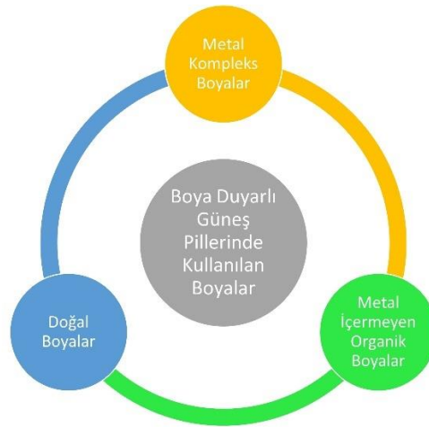
Şekil 2.4. Boya duyarlı güneş pillerinde kullanılan boya çeşitleri.
