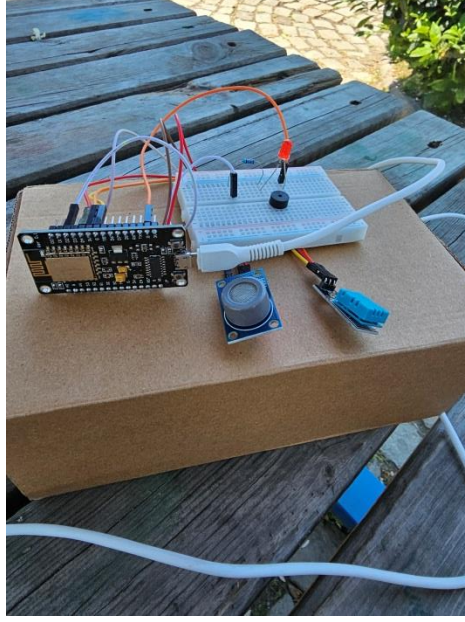
Şekil 3.5. MQ-7 sensörü bağlantısı.
