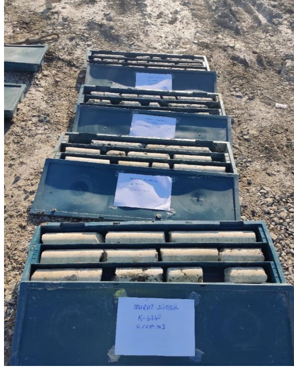
Şekil 5.7. Oluşturulan deney kolonlarına ait karot sandıklarının toplu fotoğrafı.
