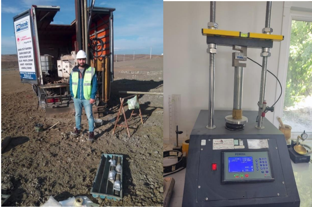
Şekil 5.3. Doğal haldeki saha zemininden numune alınımı ve serbest basma deneyi uygulanması.
