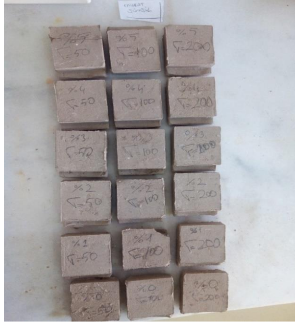
Şekil 4.20. Kesme kutusunda kesilen numunelere ait görsel.
