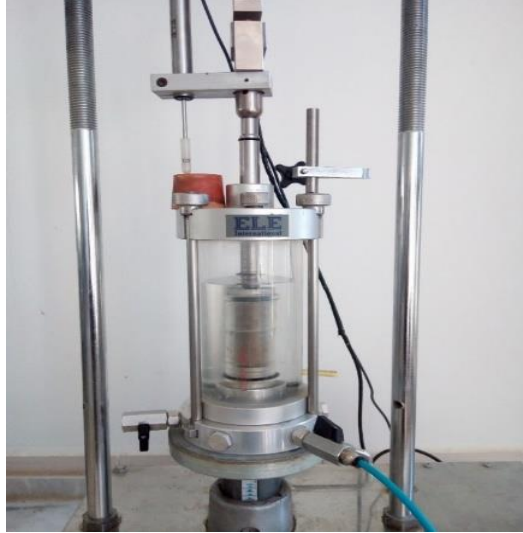
Şekil 4.25. Üç eksenli hücre kesme deneyi aleti ve uygulamasına ait görsel.
