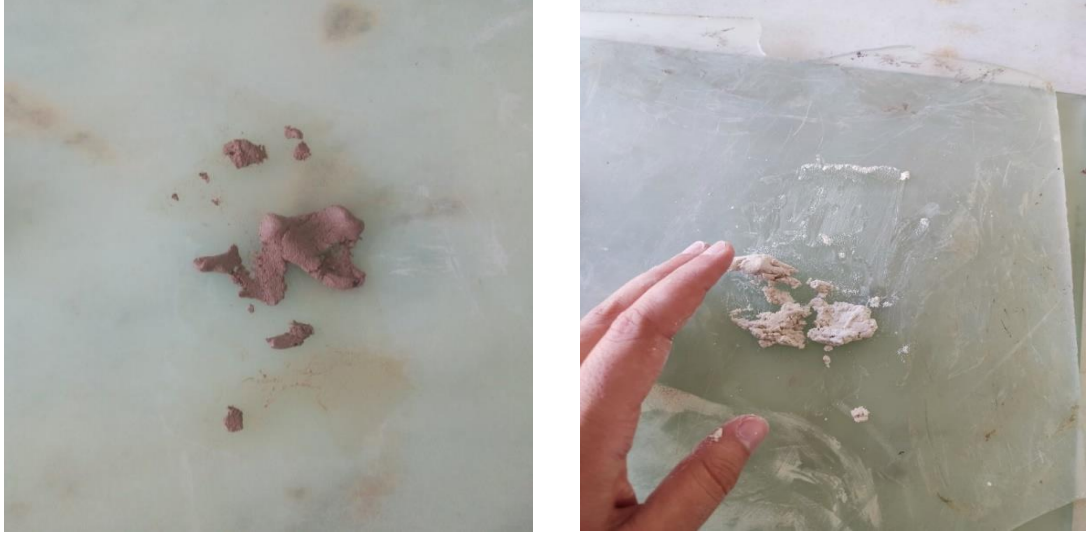
Şekil 4.3. Plastik limit yapılan siltli zemin ve CTP boru kesme atığının dağılmasına ait görsel.
