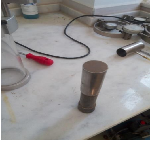
Şekil 4.24. Kompaksiyonu yapılan zeminden numune çıkarılması.
