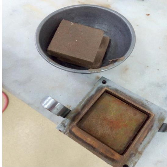
Şekil 4.19. Kesme kutusundan çıkarılan numunenin potaya alınması.
