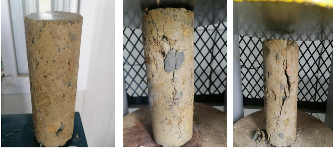
Şekil 5.8. DSM kolonu karot numunesi kırımı.
