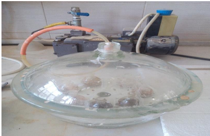
Şekil 4.12. Vakum ünitesine konulan deney numuneleri.
