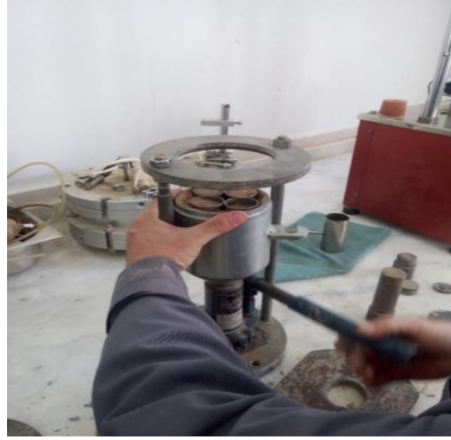
Şekil 4.24. Kompaksiyonu yapılan zeminden numune çıkarılması.
