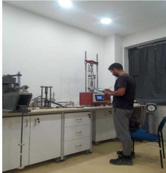
Şekil 4.26. Üç eksenli hücre kesme deneyi okuması yapılmasına ait görsel.
