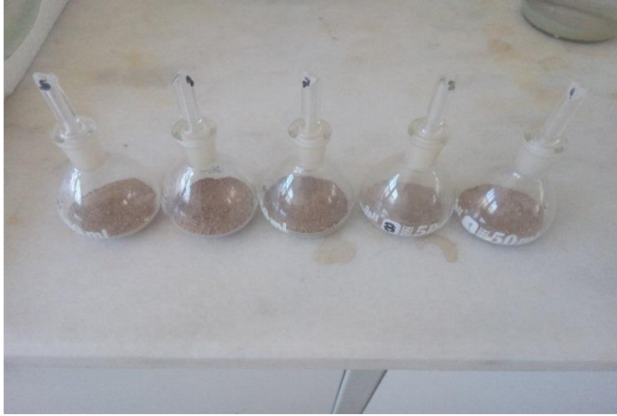
Şekil 4.11. Piknometre deneyine ait görsel.
