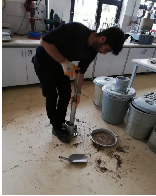
Şekil 4.15. Kompaksiyon deneyi uygulanması.
