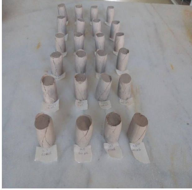
Şekil 4.27. UU deneyi yapılmış numuneleri yenilme şekilleri
