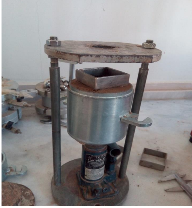
Şekil 4.18. Sıkıştırılan zeminden numune alınması işlemi.
