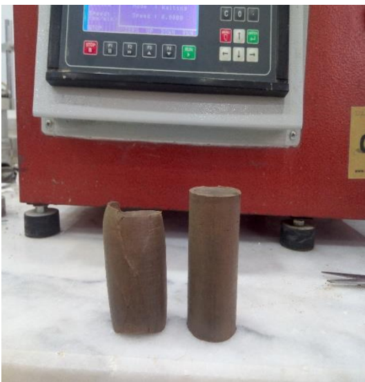
Şekil 4.26. Üç eksenli hücre kesme deneyi okuması yapılmasına ait görsel.
