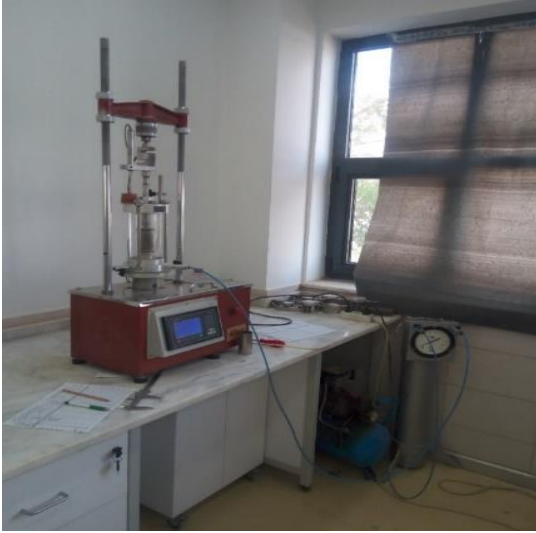
Şekil 4.25. Üç eksenli hücre kesme deneyi aleti ve uygulamasına ait görsel.
