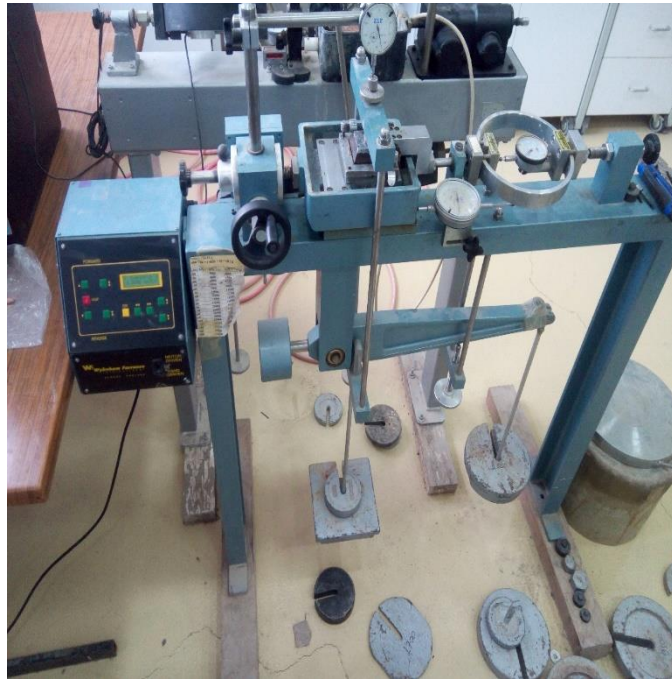
Şekil 4.17. Kesme kutusu deneyi aleti.
