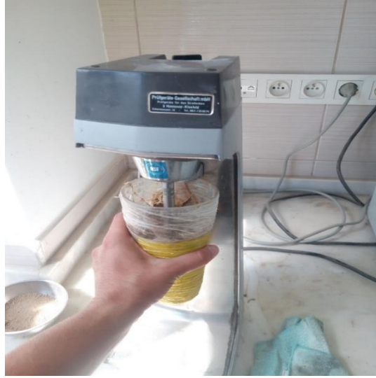
Şekil 4.7. Deney numunelerinin bünyesindeki organik maddelerin yakımı ve homojen olarak karışması için mikser ile çırılması işlemi.
