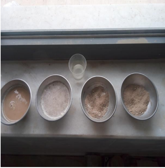
Şekil 4.7. Deney numunelerinin bünyesindeki organik maddelerin yakımı ve homojen olarak karışması için mikser ile çırılması işlemi.
