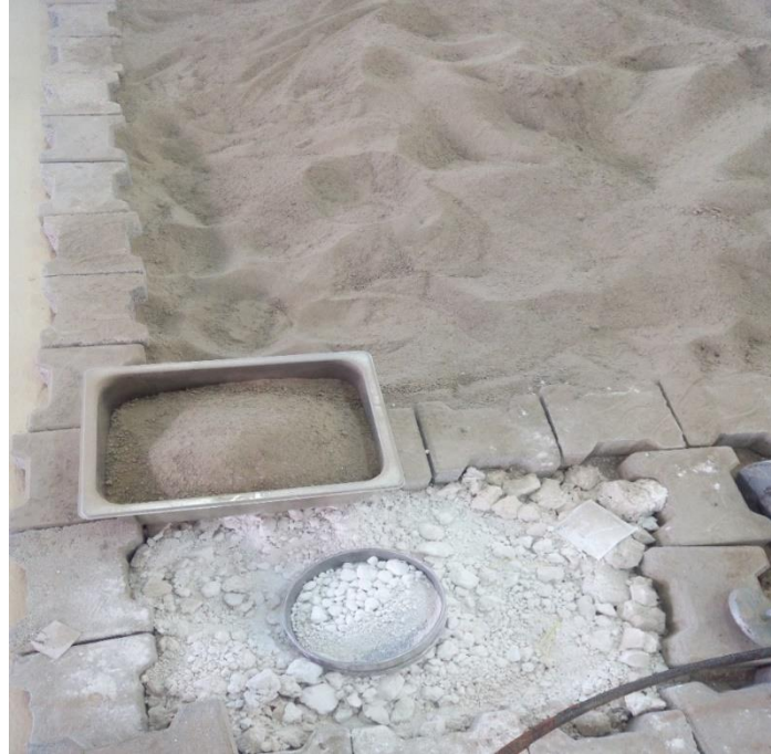
Şekil 4.1. Laboratuvar ortamında kurumaya bırakılan CTP boru kesme atığı ve siltli numuneler.
