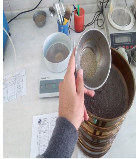
Şekil 4.9. Hidrometre deneyi sonrası numunelerin yıkanması ve elek takımından geçirilmesi.
