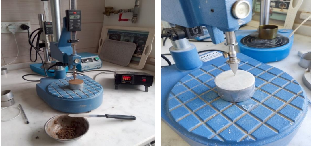
Şekil 4.4. Siltli zemin koni düşürme deneyi.
