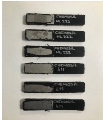
Resim 3.9. Vulkanizasyon Yöntemi İle Birleştirilen Lastik + Metal Test Numuneleri
