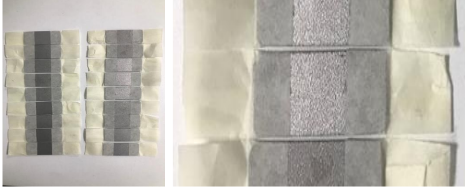
Resim 3.3. Maskeleme Yapılmış Metal Numuneler
