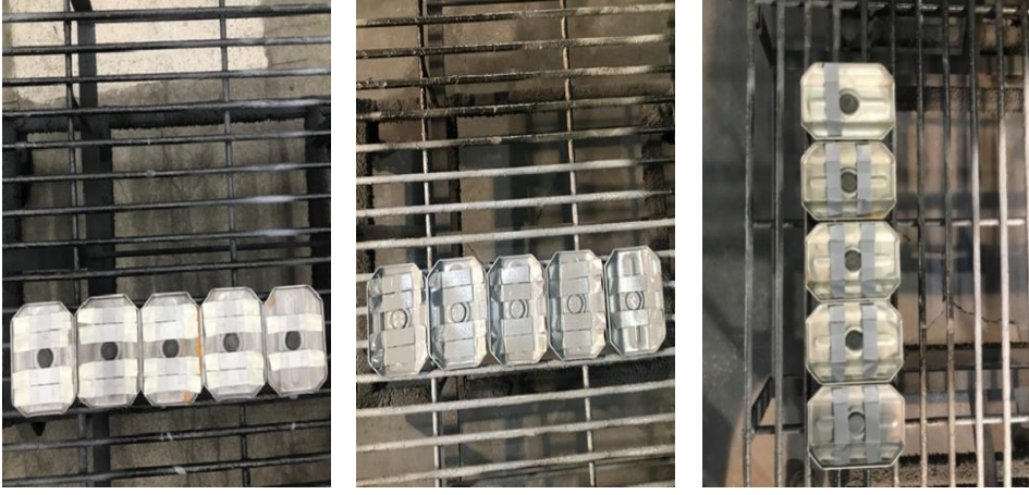
Resim 3.4. Chemosil 211 Astarlama İşlemleri.
