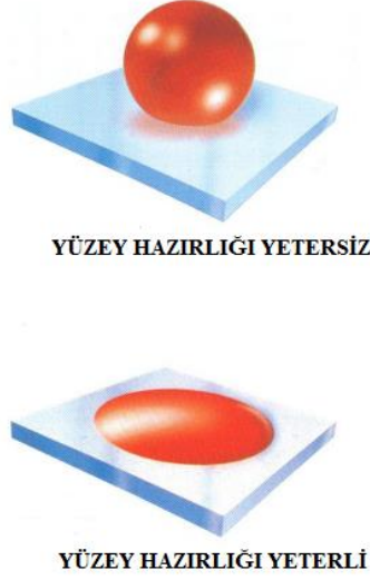
Şekil 2.16. Yüzey Hazırlığı, “Su Kopma” Testi veya Belirli Yüzey Gerilim Sıvıları ile Test Edilmesi [8].
