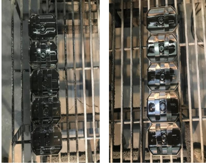
Resim 3.5. Yapıştırıcı Uygulamasının Yapılması. (Chemosil NL222, Chemosil 411)
