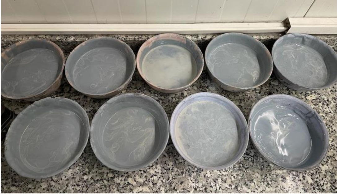
Şekil 5.2. Yaş olarak öğütülmüş emayeler (Algotrio Kimya 2022)
