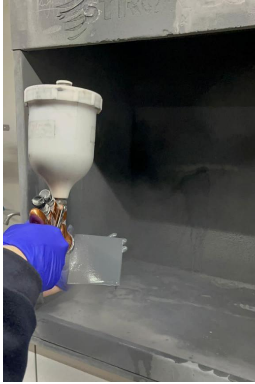
Şekil 2.8. Manuel sprey yöntemi ile uygulama (Algotrio – 2022)
