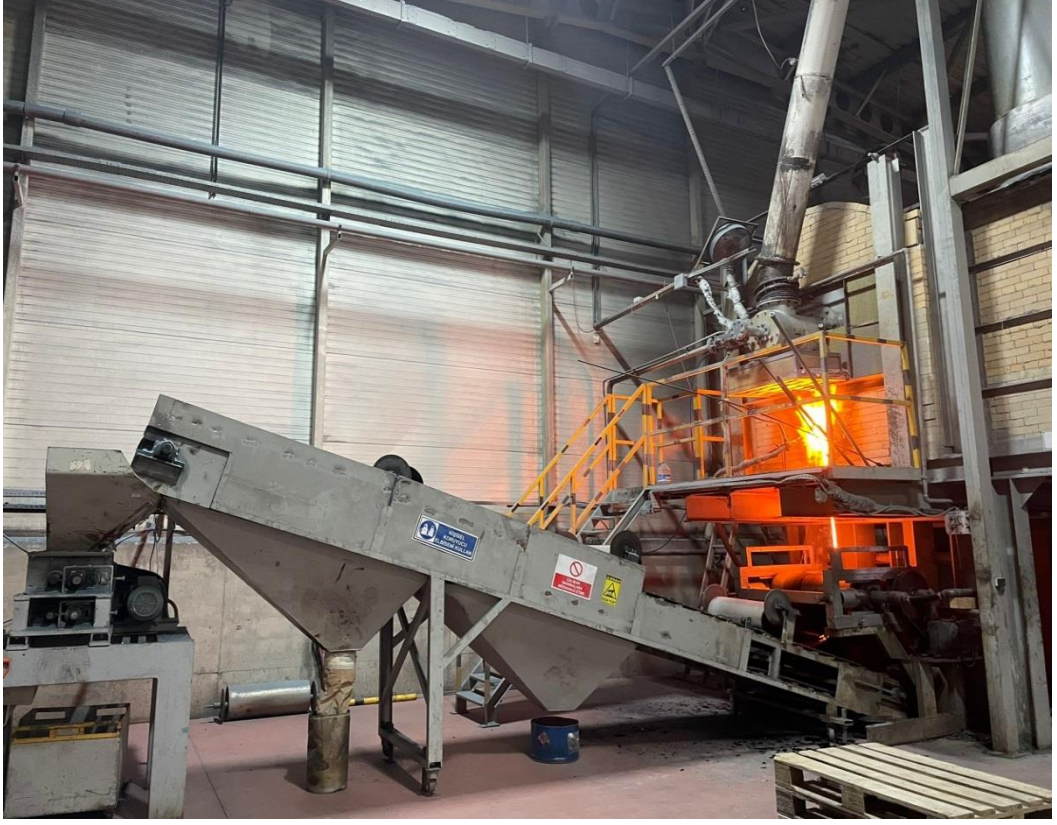
Şekil 2.2. Emaye Friti Üretim Fırını (Algotrio Kimya – 2022)
