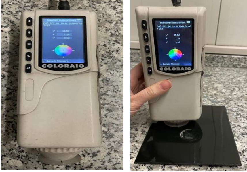
Şekil 3.5. El tipi renk ölçüm cihazı ve ölçüm yöntemi (Algotrio Kimya 2022)
