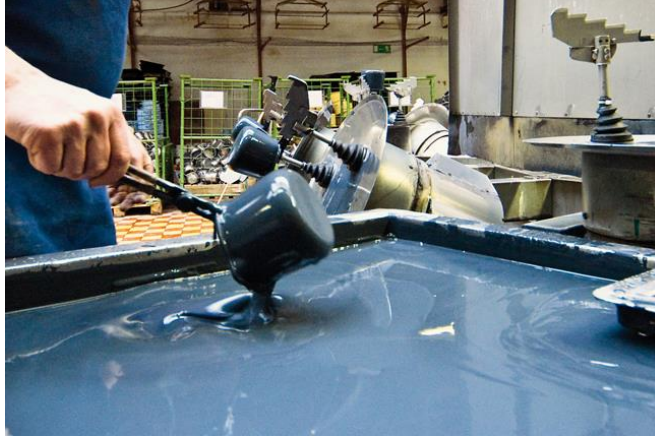
Şekil 2.15. Astar emayenin daldırma yöntemi ile kaplanması
