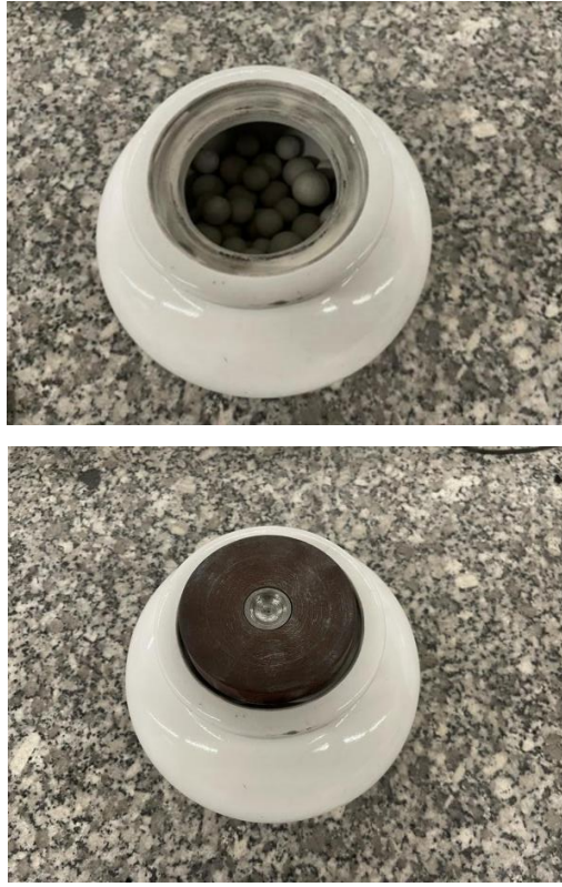
Şekil 2.4. Emaye öğütme değirmeni (Algotrio Kimya 2022)
