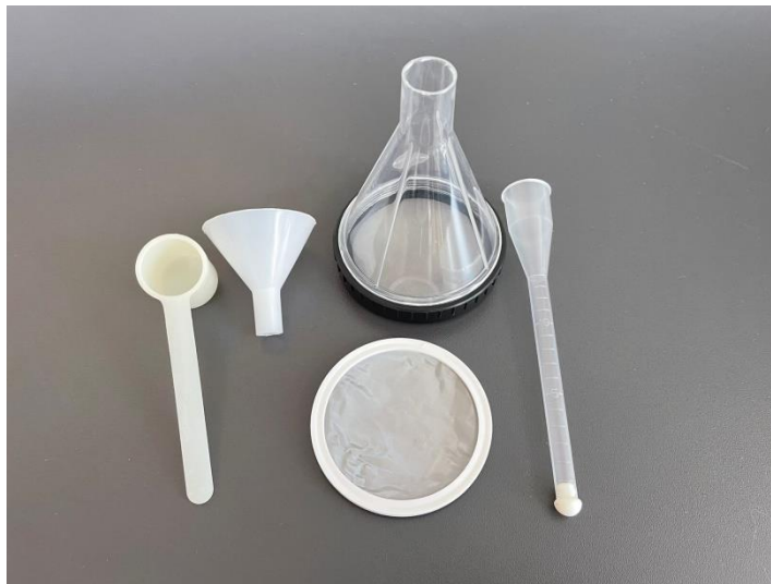
Şekil 3.8. Tane boyutu ölçümü yapılan Bayer elek seti (Algotrio Kimya-2022)
