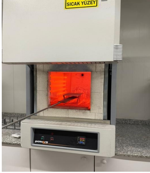
Şekil 5.4. Emaye kaplı plaka pişirme fırını (Algotrio Kimya 2022)
