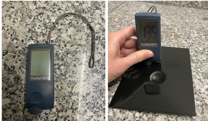
Şekil 3.3. Kaplama kalınlığı ölçüm cihazı ve ölçüm yöntemi (Algotrio Kimya 2022)
