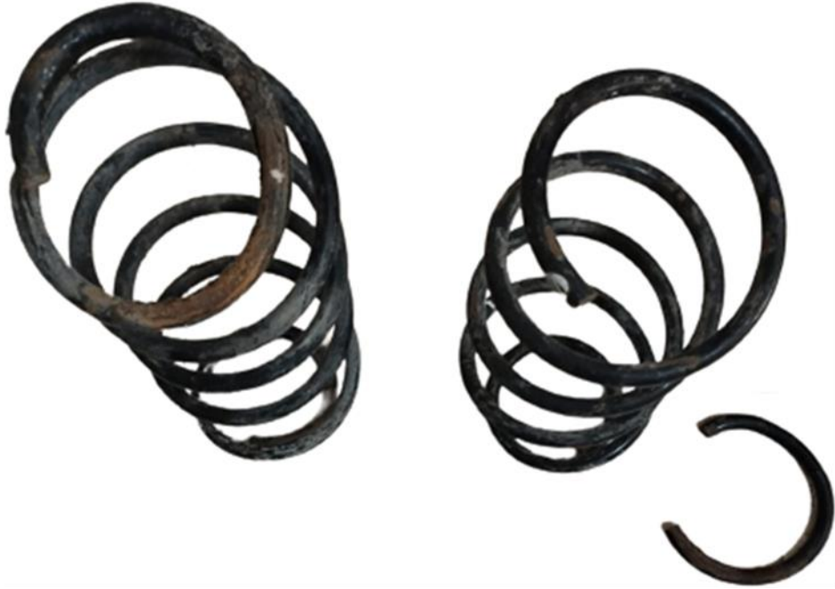
Şekil 3.1. Değiştirilen amortisör yayları
