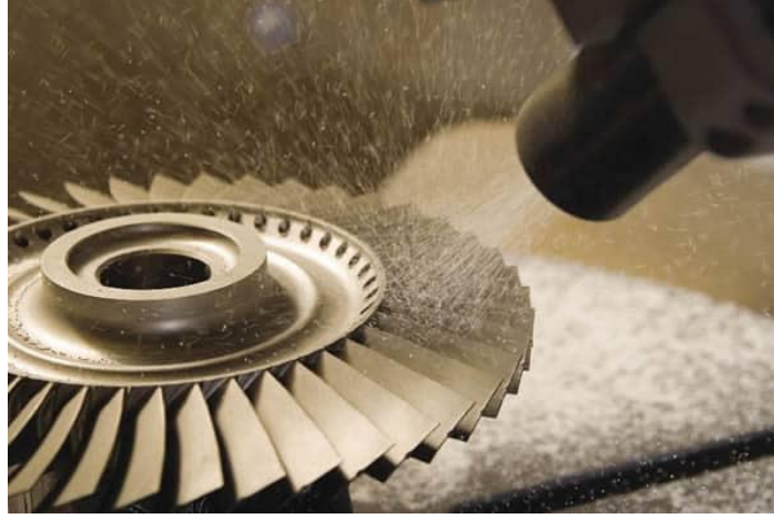
Şekil 3.15. Dişli bir parçaya yapılan kumlama işlemi.
