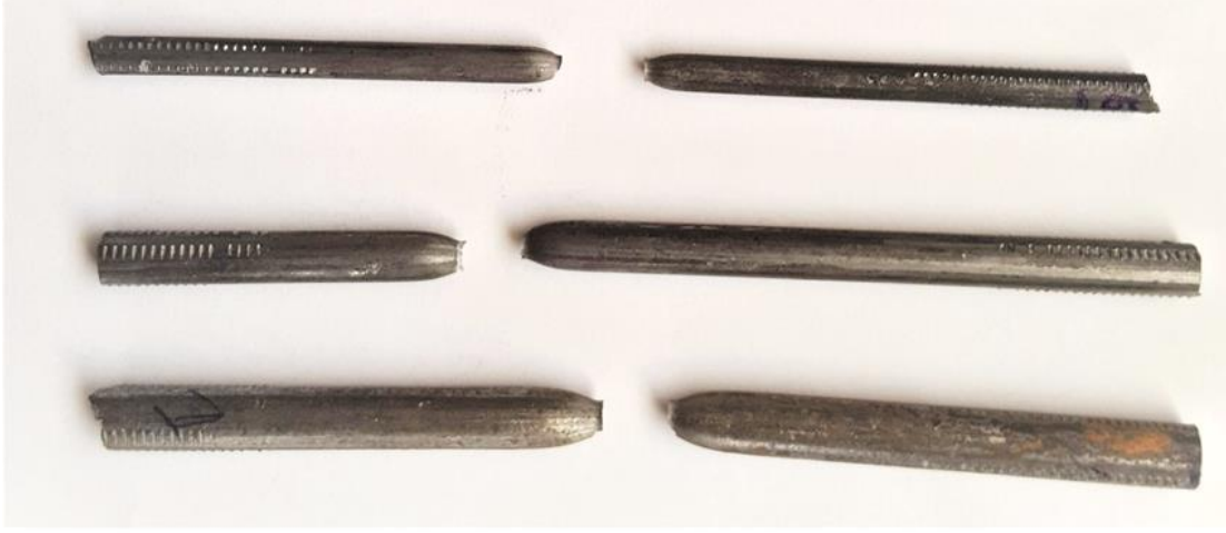
Şekil 3.1. Çekme testi sonrası kopmuş SAE 1008 çelik tel numuneler.
