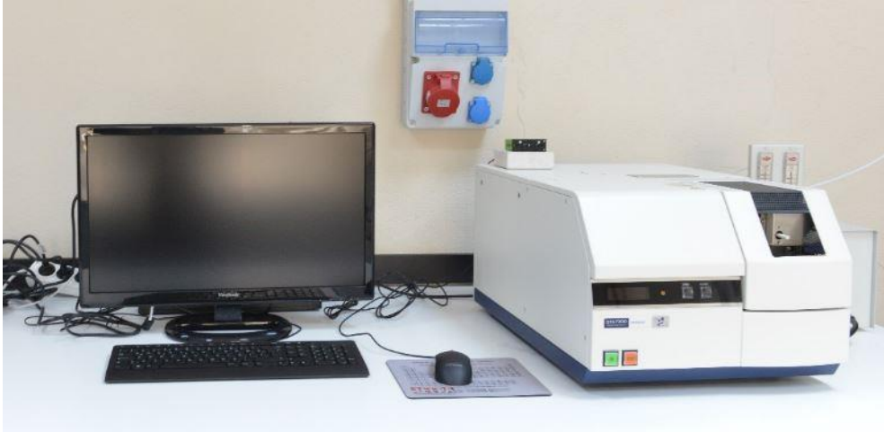
Şekil 3.4. HITACHI STA 7300 marka termal analiz cihazı.
