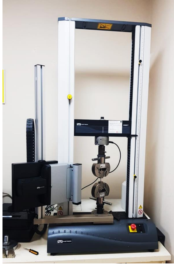
Şekil 3.4. INSTRON marka çekme cihazı.
