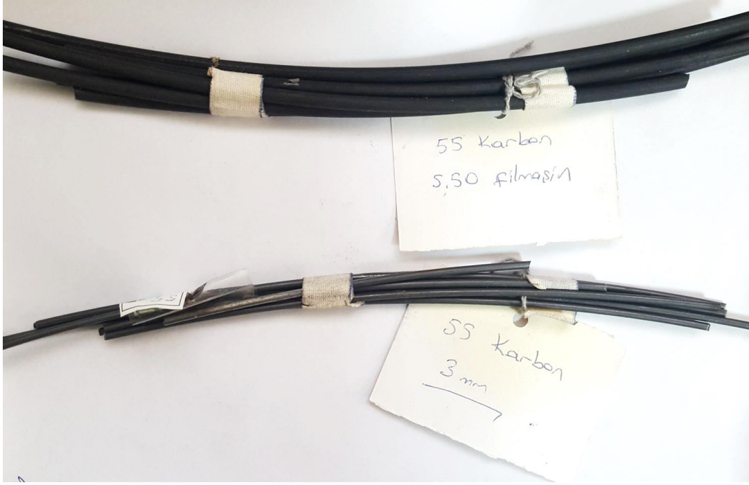
Şekil 3.1. Deneysel çalışmalarda kullanılan C55 çelik tel numuneler.
