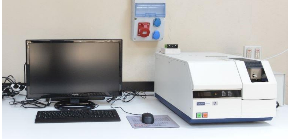
Şekil 3.5. HITACHI STA 7300 marka termal analiz cihazı.
