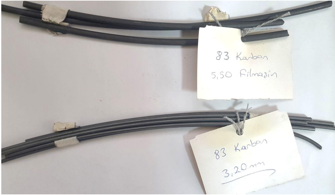
Şekil 3.2. Deneysel çalışmalarda kullanılan C83 çelik tel numuneler.
