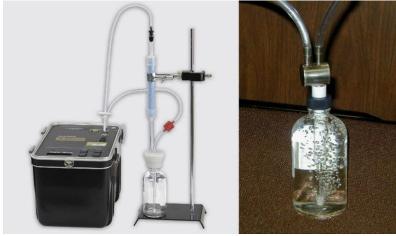
Şekil 2.7. Su Numunelerinin RAD-7 H 2 O dedektörüne bağlanması ve su numunelerinin köpürtülmesi [49].
