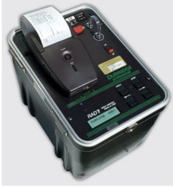
Şekil 2.3. RAD-7 (Durridge Co, USA) radon detektörü [49].
