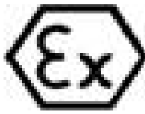
Şekil 4.3. Teçhizatın patlamaya karşı korunma özel işareti örneği
