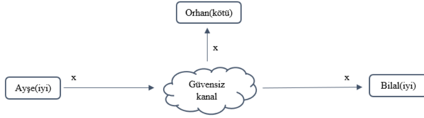
Şekil 2.3. Güvensiz kanal üzerinden iletişim.
