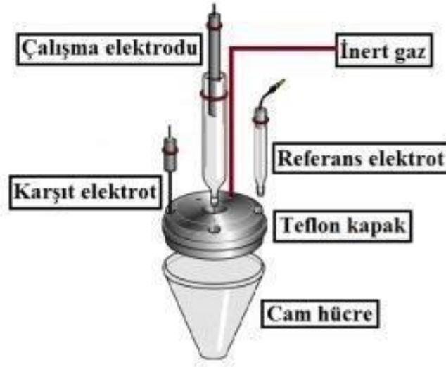
Şekil 2.3. Üç elektrotlu bir sistemin şeması.
