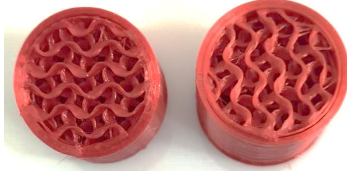
Şekil 3.6. 3D yazıcıda üretilen kemik modellerinin iç yapısı.
