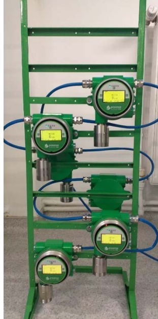
Şekil 7.2. Dedektör Modbus bağlantı yapısı
