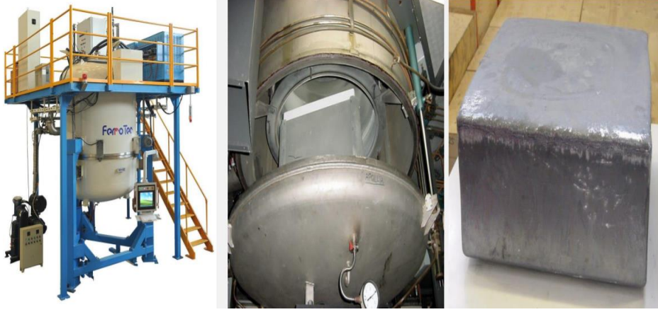
Şekil 2.6. Silisyum külçelerin doğrudan katılaştırılması [36].
