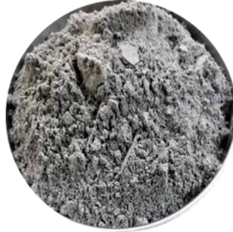
Görsel 16: Kalsine Edilmiş ve Öğütülmüş Üzüm Cibresi Külü
