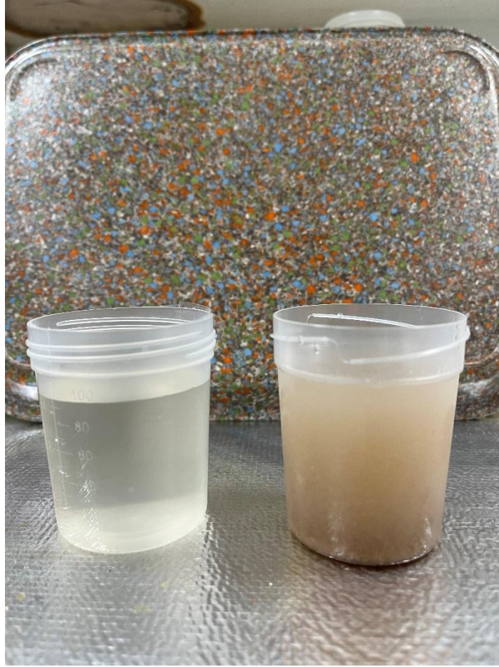
Şekil 5.4. Gerçek gri su numunesi ve arıtılmış gri su numunesi
