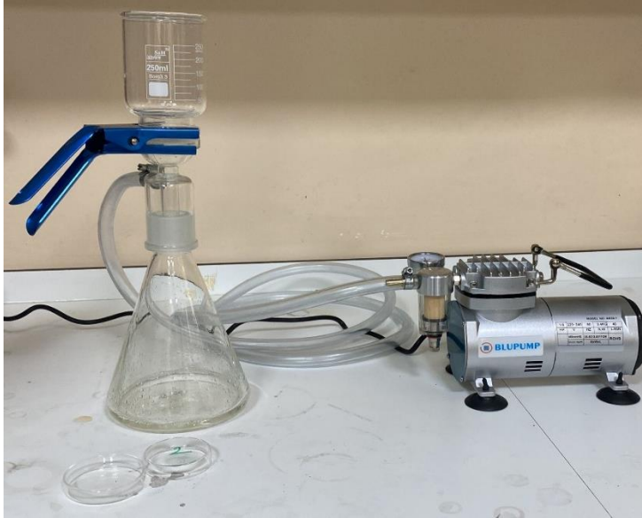
Şekil 4.6. Askıda katı madde deneyinde süzme işlemi
