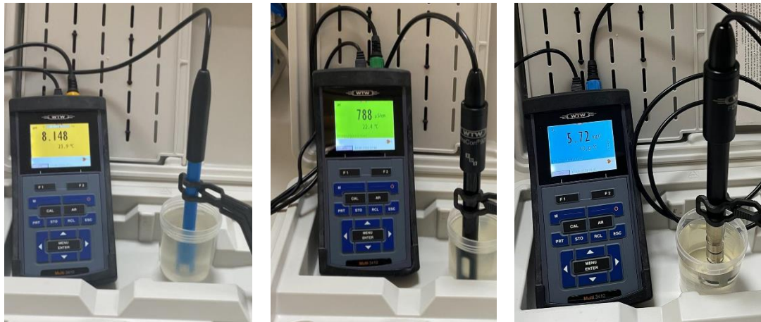
Şekil 4.5. pH , elektriksel iletkenlik, çözünmüş oksijen ölçümleri
