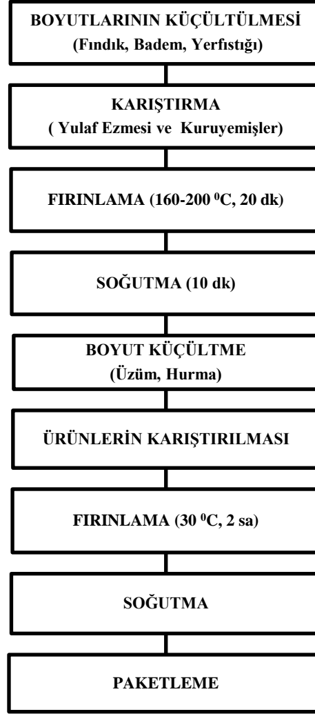
Şekil 6.2. Granola üretim sürecinin akış şeması (Dikyokuş, 2022).
