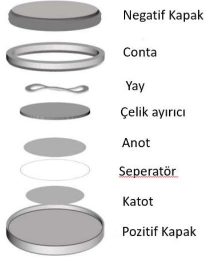
Şekil 4.2. Yarım hücre montajı [120].
