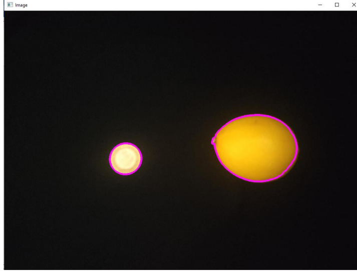
Şekil 4.6 Resimde algılanan nesnelerin kontür(contours) çizimi
