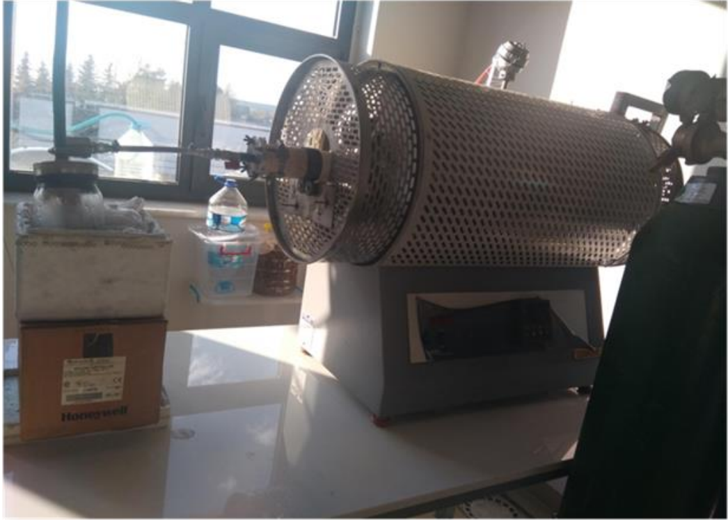
Şekil 5.4. Dinamik Termokimyasal işlemlerin gerçekleştiği fırın
