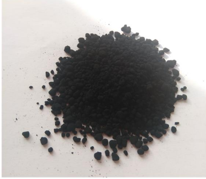
Şekil 5.3. Hazırlanan karışımlardan elde edilen granüller ( \text{SiO}_2 + \text{C} )
