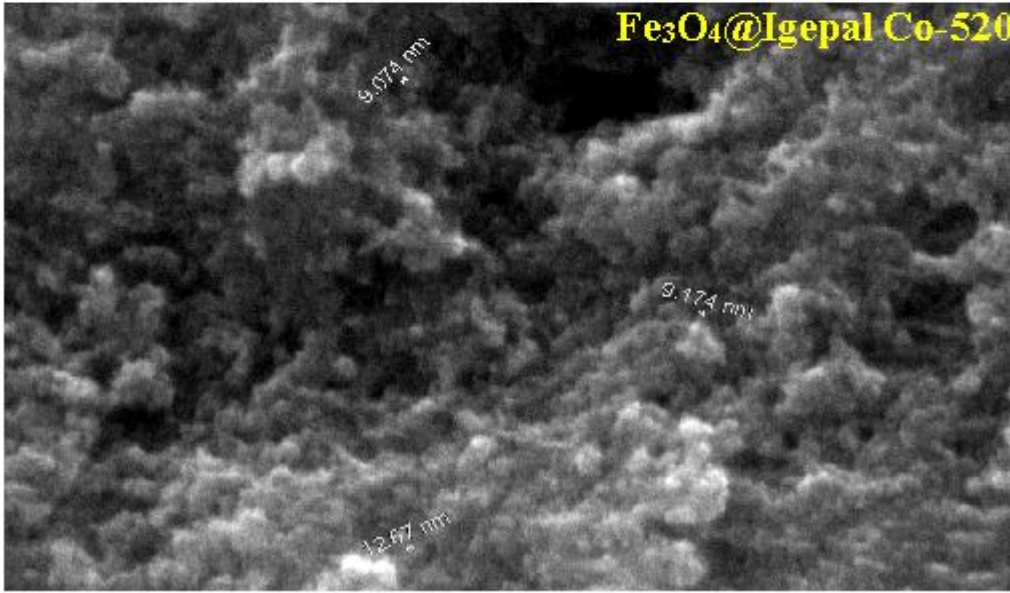
Şekil 5.2. Fe_3O_4 ile Fe_3O_4@Igepal\ Co-520 FESEM görüntüsü
