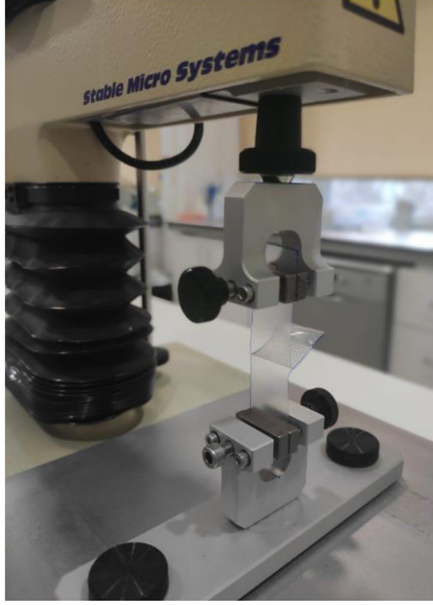
Şekil 2.1. Isıl yapışma mukavemeti test düzeneği
