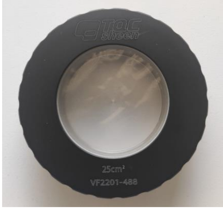
Şekil 2.2. Su buharı geçiş hızı (WVTR) ölçümü için hazırlanan örnek
