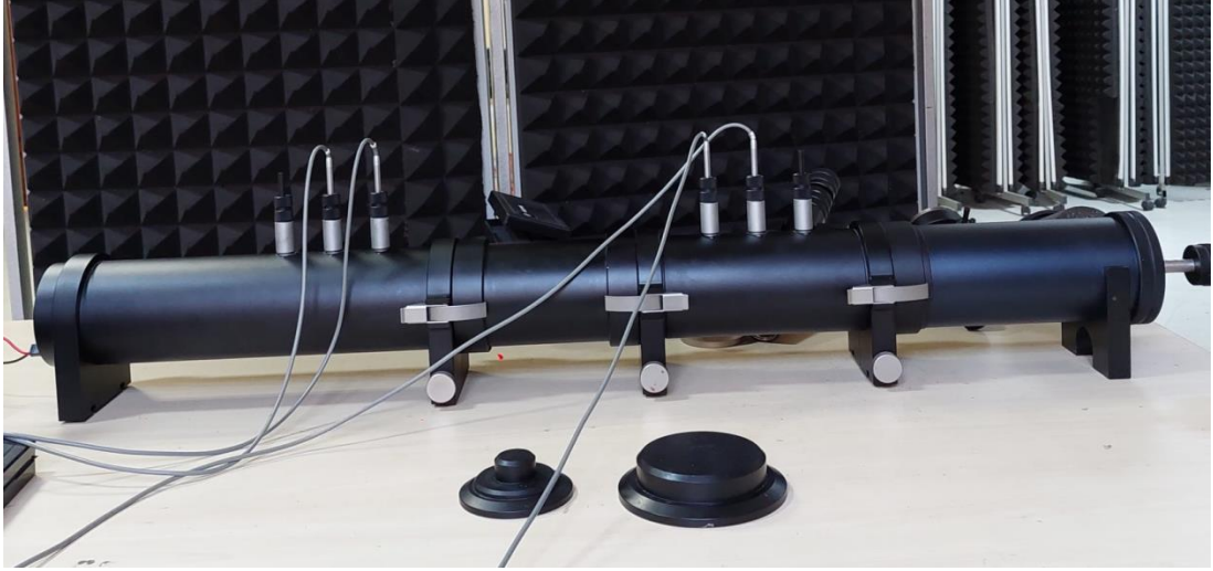
Şekil 3.29. Ses iletim kaybı için kullanılan geniş tüpün gösterimi
