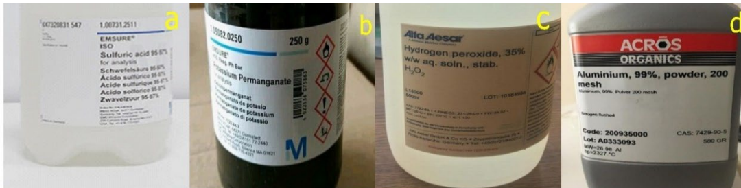
Şekil 5.1. Kullanılan Malzemeler (a) Sülfirik Asit ( H_2SO_4 ), (b)Potasyum Permanganat ( KMnO_4 ), (c)Hidrojen Peroksit ( H_2O_2 ), (d) Alüminyum tozu (Al)
