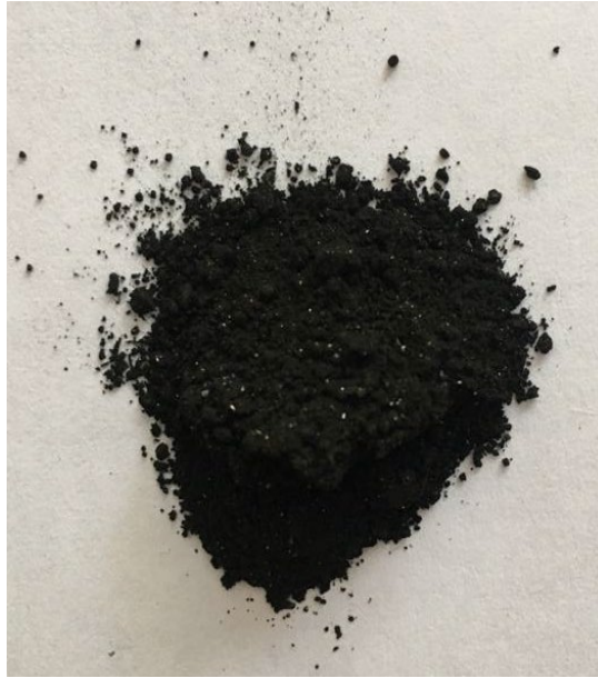
Şekil 5.3. Ni-P banyosunda kaplanmış GO numunesi
