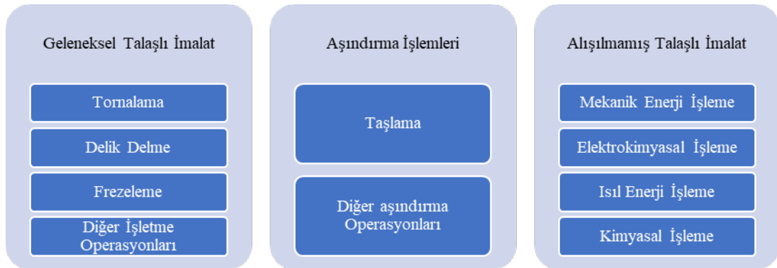
Şekil 2.3. Malzeme kaldırma İşlemleri sınıflandırılması
