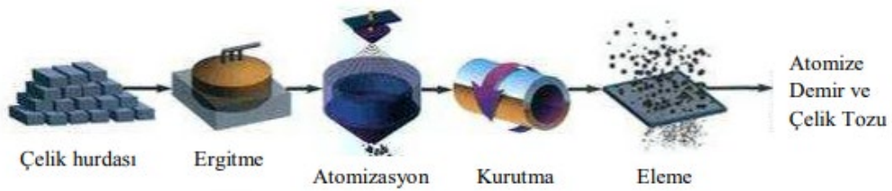
Şekil 2.7. Atomizasyon ile toz üretim aşamaları [41]
