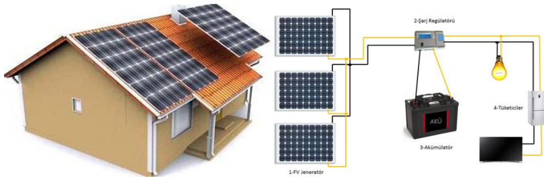
Şekil 2.9. Fotovoltaik güneş enerji paneli (Güneş Paneli Çalışma Prensibi, 2022)
