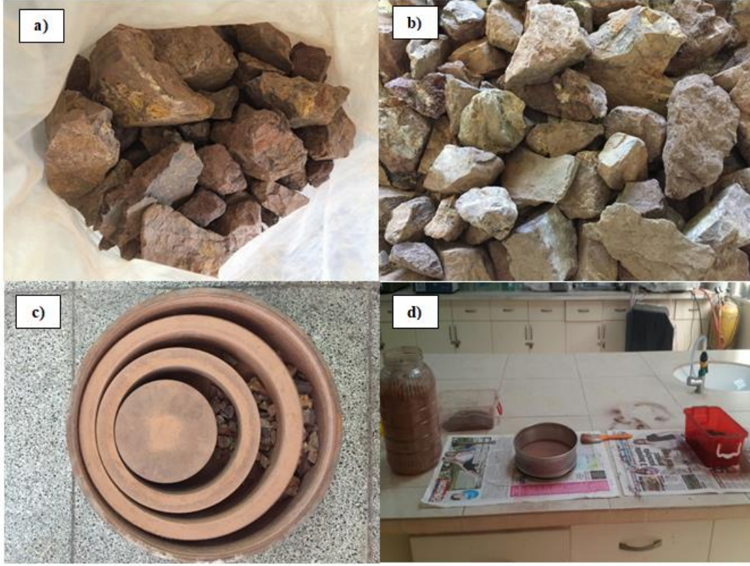
Şekil 3.2. a) Temin edilen cevher, b) kırma, c) öğütme, d) eleme.
