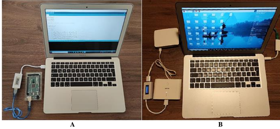
Şekil 3.15. Test edilen sistemin donanım düzeni (A, Arduino Mega kullanarak- B, Raspberry Pi kullanarak).
