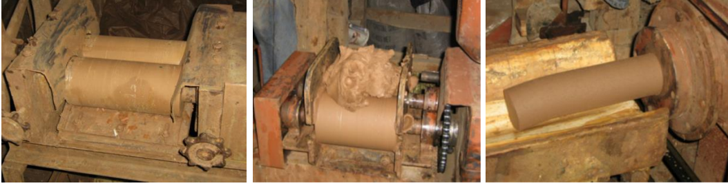
Görsel 120: Ezici Vals ve Vakum Pres Makinesine Çamurun Girişi ve Çıkışı
