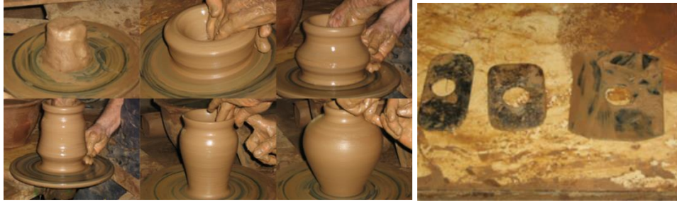
Görsel 122: Çamurun Biçimlendirilmesi ve Biçimlendirme Kullanılan Taraklar
