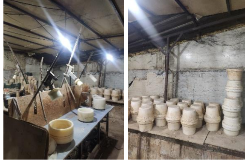
Görsel 50: Çamur Biçimlendirmede Kullanılan Şablon Tornalar ve Alçı Kalıplar Kaynak: Yazar Arşivi
