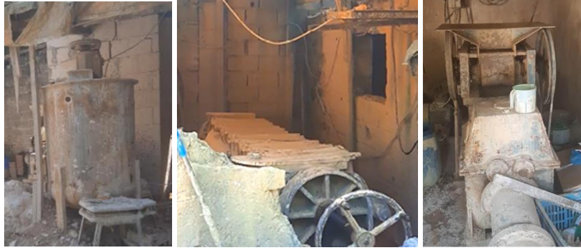
Görsel 109: Karma, Filtre Pres, Ezici Vals ve Vakum Pres Makineleri
