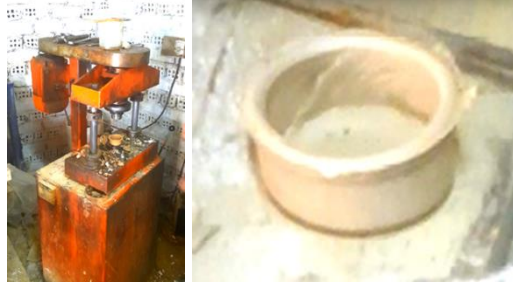
Görsel 112: Hidrolik Pres Makinesi ve Makinede Biçimlendirilen Form
