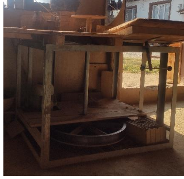
Görsel 5: Günümüzde Motor Takılarak Elektrikle Kullanılan Ayak Torna Örneği Kaynak: Yazar Arşivi
