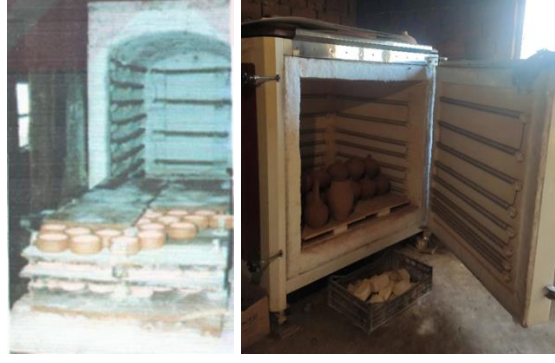
Görsel 39: Önden Yüklemeli Gazlı Fırın ve Elektrikli Fırın
