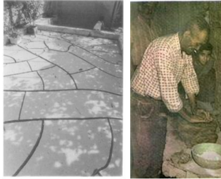
Görsel 90: Çökertme Havuzunda Çatlamış Çamur ve Çamurun Yoğrulması Kaynak: (Tekkök-Biçken, 2000, s. 97), (Güner, 1988)
