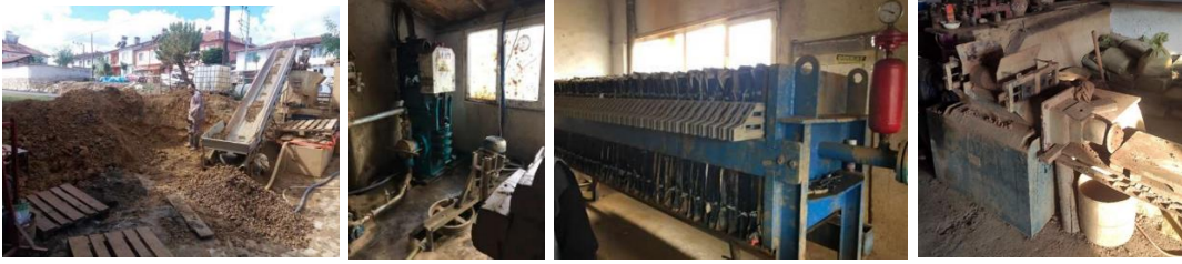
Görsel 28: Günümüz Çamur Hazırlama Sürecinde Kullanılan Titreşimli Elek, Pervaneli Karıştırıcı, Filtre Pres ve Vakum Pres makineleri
