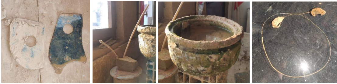
Görsel 30: Biçimlendirme Kullanılan Yardımcı Aletler; Puçula, Deveboynu, Ölçme Çubuğu, Su Dolu Kap ve Bakır Kesme Teli
