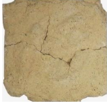
Görsel 44: %13 Perlit Katkılı Şamotlu Bünye
