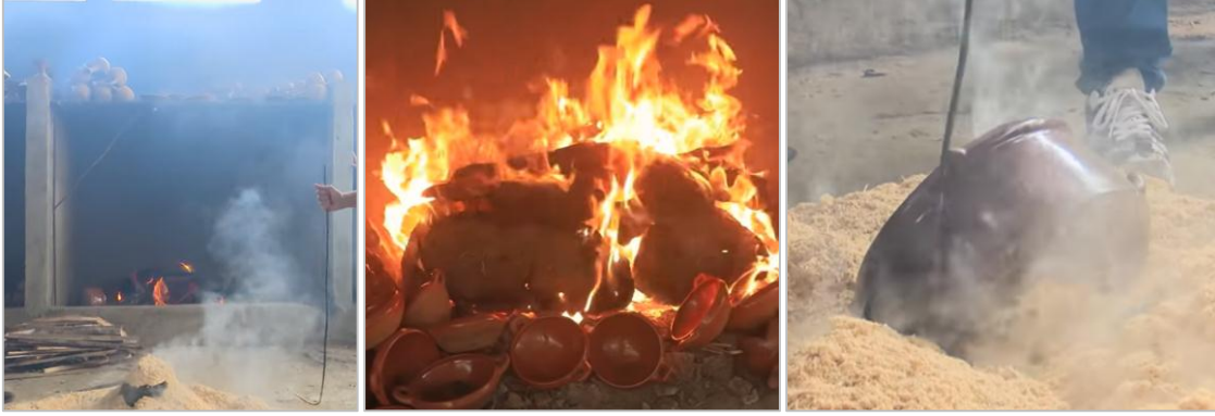
Görsel 30: Fırın, Formların Pişirilmesi ve İndirgeme İşlemi
