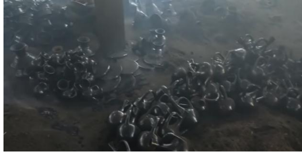
Görsel 31: İndirgeme işlemi Sonrası Soğumaya Bırakılan Jebenalar
