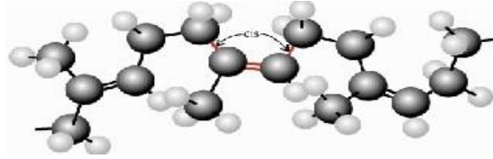
Şekil 3.4. Cis 1-4 Poli İzopren Polimeri [55].
