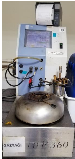
Şekil 4.9. Herzog HFP 360 Flash Point Cihazı
