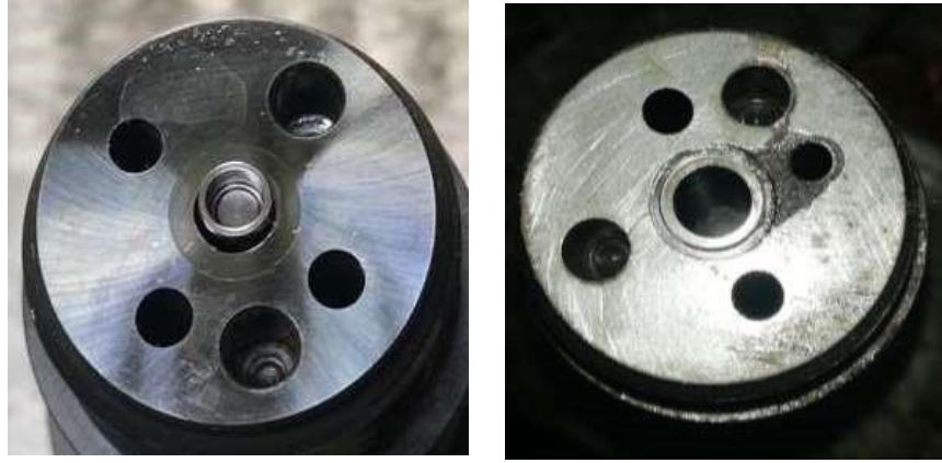
Şekil 5.11. Enjektör Nozul Basma Yüzeyleri a)Yeni Enjektör b)Kullanılmış Enjektör
