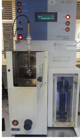
Şekil 4.3. Herzog HDA 627 Atmosferik Destilasyon Cihazı
